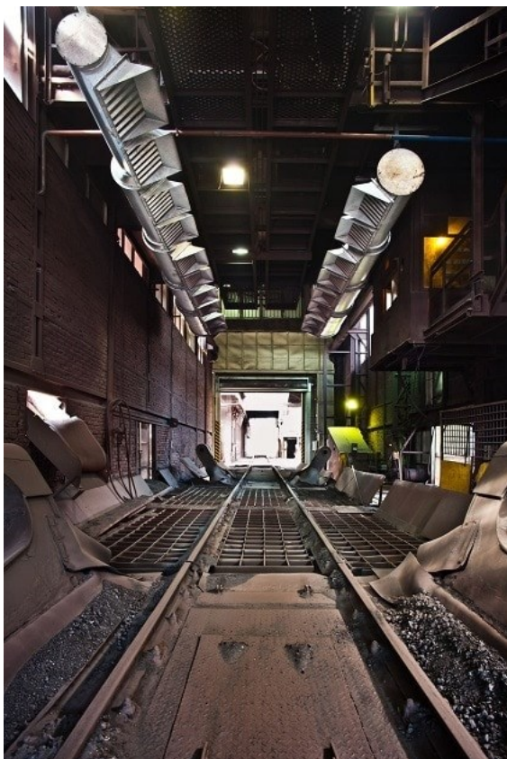
Obr. 3, příklad odsávání stacionárního zdroje, manipulace s uhlím
