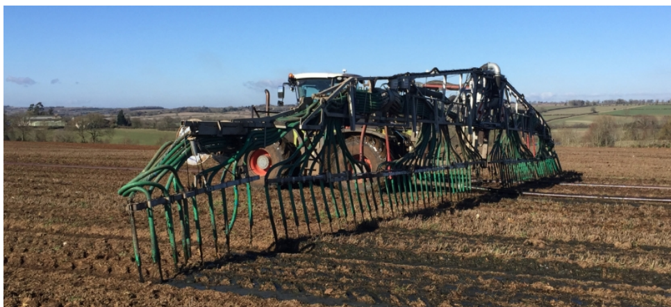
Obr. 21: Nízkoemisní způsob aplikace kejdy hadicovým aplikátorem
