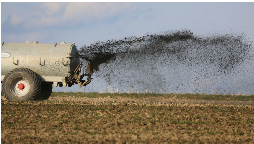
Obr. 20: Referenční způsob aplikace kejdy prostým rozstříkem kejdy na povrch půdy
