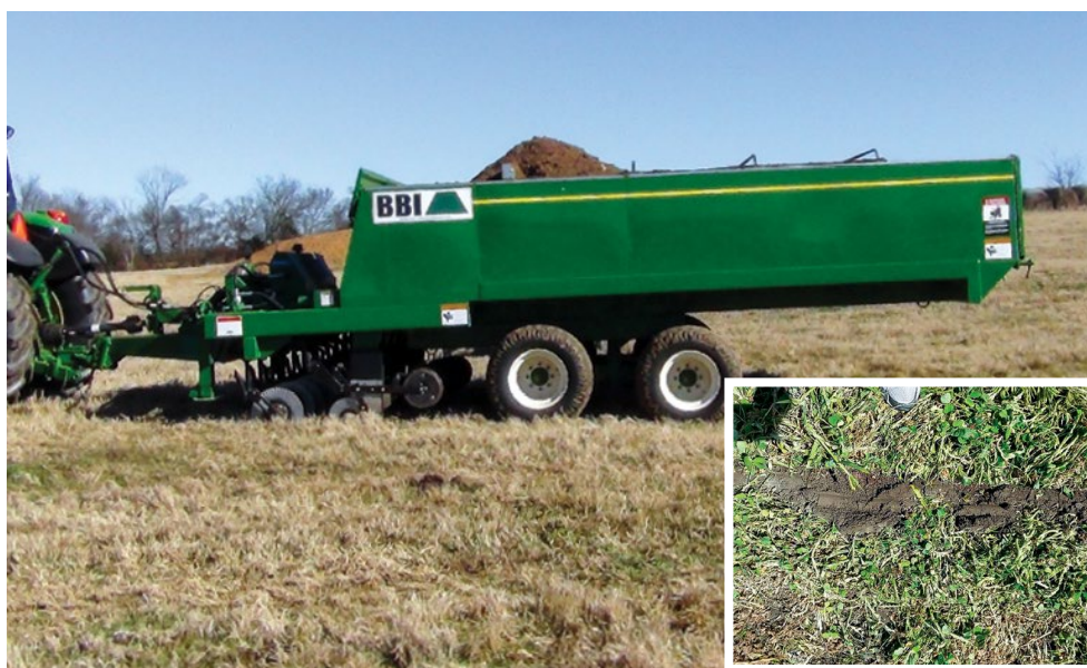
Obr. 28: Technika pro přímou aplikaci drůbežího trusu pod povrch půdy
