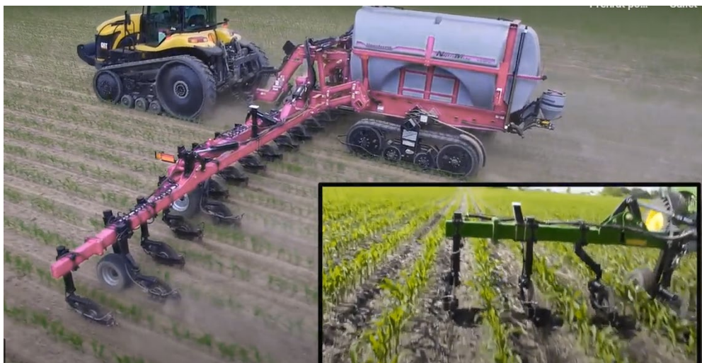
Obr. 32: Technika pro přímou aplikaci granulovaných minerálních hnojiv během setí obilovin
