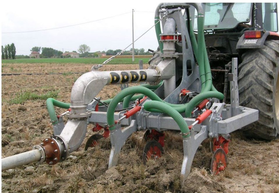
Obr. 24: Nízkoemisní způsob aplikace kejdy hlubokou injektáží přímo do půdy
