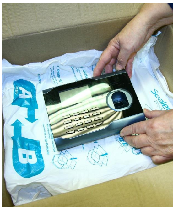
Obrázek 1 – Fixace elektrozařízení v obalu pomocí pěnových fólií
