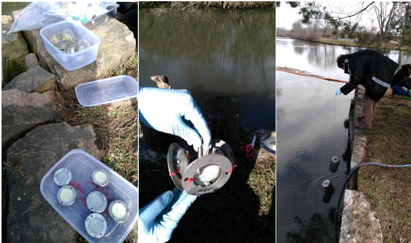
Obrázek 7. Instalace pasivních vzorkovačů v terénu. Plastová vzorkovnice na transport a uskladnění vzorkovače je na obrázku nahoře vlevo. Střední obrázek ukazuje umístění vzorkovačů do držáku, který se pak umístí do ochranné klece z perforovaného nerezového plechu (v pozadí). Na fotografii vpravo je demonstrováno umístění vzorkovačů v ochranných klecích do vody za pomoci lana.
