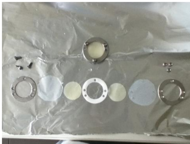
Obrázek 4. Schéma konstrukce pasivního vzorkovače založeného na principu adsorpce polárních látek z vodního prostředí do adsorbentu dispergovaného v agarozovém hydrogelu. Přestup látky z vody do vzorkovače je kontrolován difúzí ve vrstvě čistého agarozového hydrogelu.
