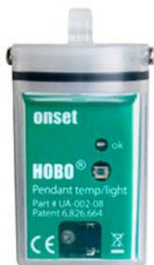
Obrázek 10. Ponorný záznamník teploty – připevní se pomocí stahovacího pásku na rám vzorkovacího zařízení při jeho expozici ve vodě.
