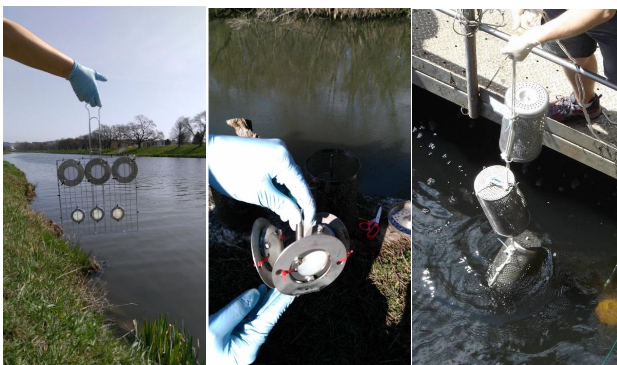
Obrázek 6. Příklady různých způsobů instalace pasivních vzorkovačů v terénu
