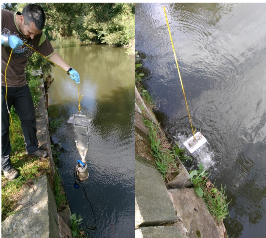
Obrázek 19 Zařízení pro dynamické pasivní vzorkování během instalace. Ponorné čerpadlo (viditelné na spodním okraji zařízení na levé straně) žene proud vody velkou rychlostí do průtokové komory nad ním. Voda stříká tryskem z komory a proud vody je tlumen ochrannou stříškou nad ústím komory. Během provozu je celé zařízení úplně ponořeno do vody. Na obrázku vpravo je zařízení povytaženo z vody kvůli lepší viditelnosti.
