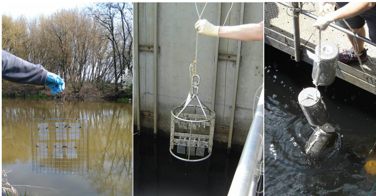
Obrázek 3 Příklady různých způsobů instalace pasivních vzorkovačů na bázi silikonové pryže v terénu.
