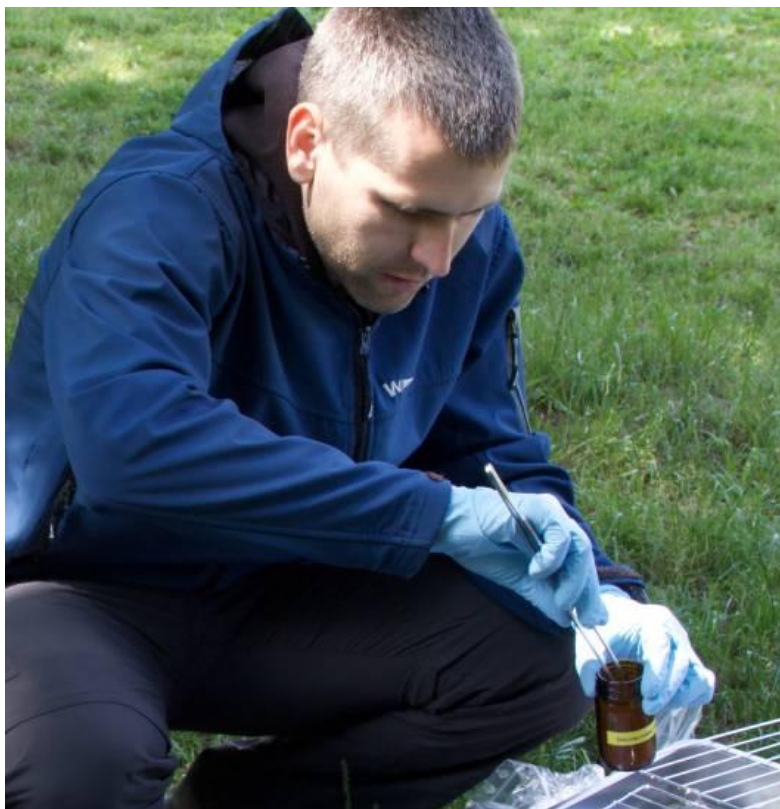
Obrázek 10 Vkládání vzorkovačů do vzorkovnice po odběru pomocí pinzety.
