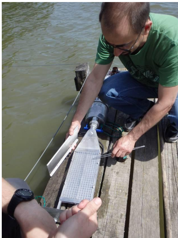
Obrázek 16 Montáž vzorkovače na bázi silikonové pryže AlteSil do vzorkovacího zařízení pro dynamické pasivní vzorkování (použit pinzety)
