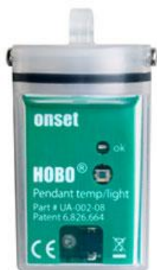
Obrázek 18 Ponorný záznamník teploty – připevní se pomocí stahovacího pásku na rám vzorkovacího zařízení při jeho expozici ve vodě.
