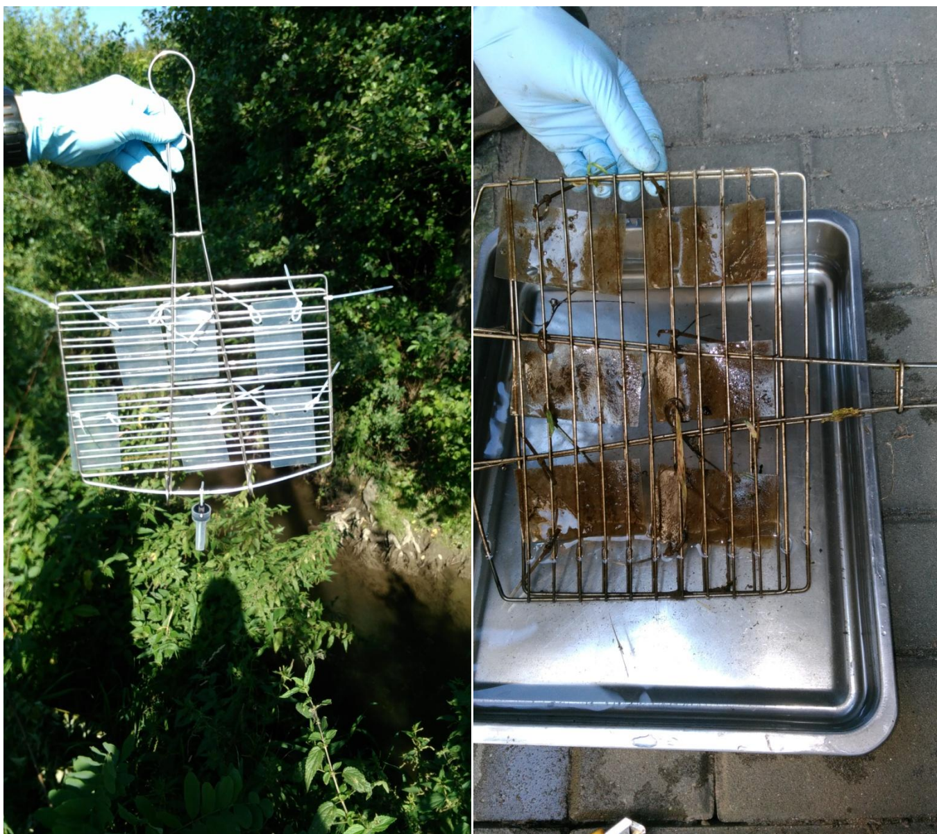
Obrázek 8 Pasivní vzorkovač před (obr. vlevo) a po (obr. vpravo) 28 - denní expozici v povrchové vodě.
