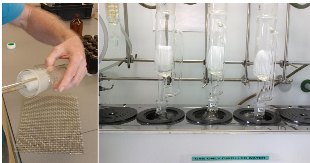
Obrázek 20 Soxhletova extrakce naskládaných plátů silikonové pryže
