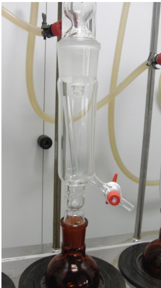
Obrázek 21 Kuderna-Danish odpařovací aparatura pro snížení objemu extraktu
