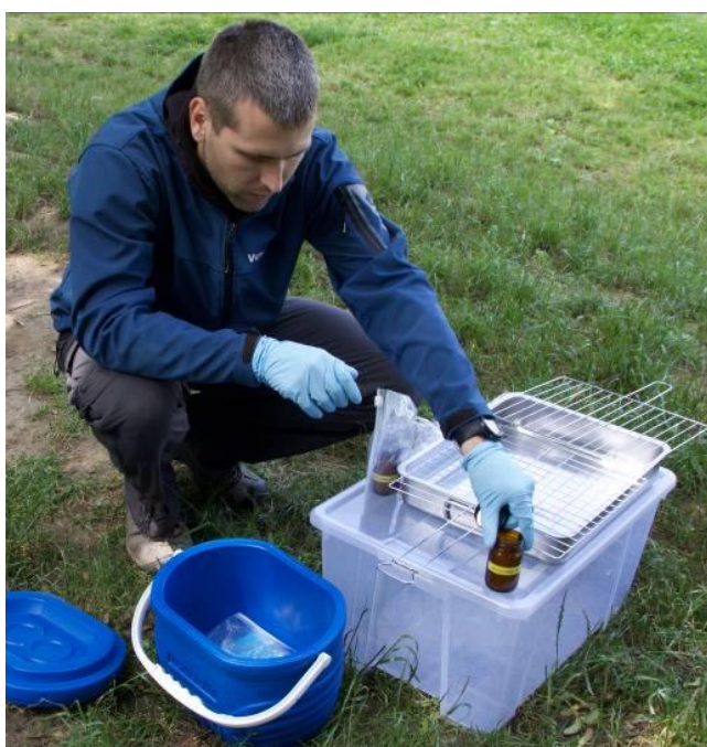
Obrázek 4 Příprava pasivních vzorkovačů na instalaci v terénu. Vzorkovnice na transport a uskladnění vzorkovače je na obrázku vlevo nahoře.
