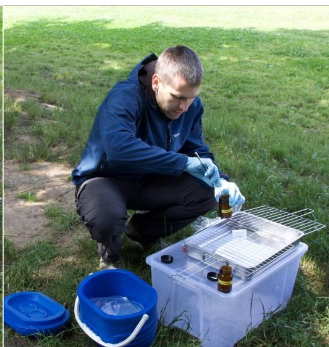
Obrázek 4 Příprava pasivních vzorkovačů na instalaci v terénu. Vzorkovnice na transport a uskladnění vzorkovače je na obrázku vlevo nahoře.
