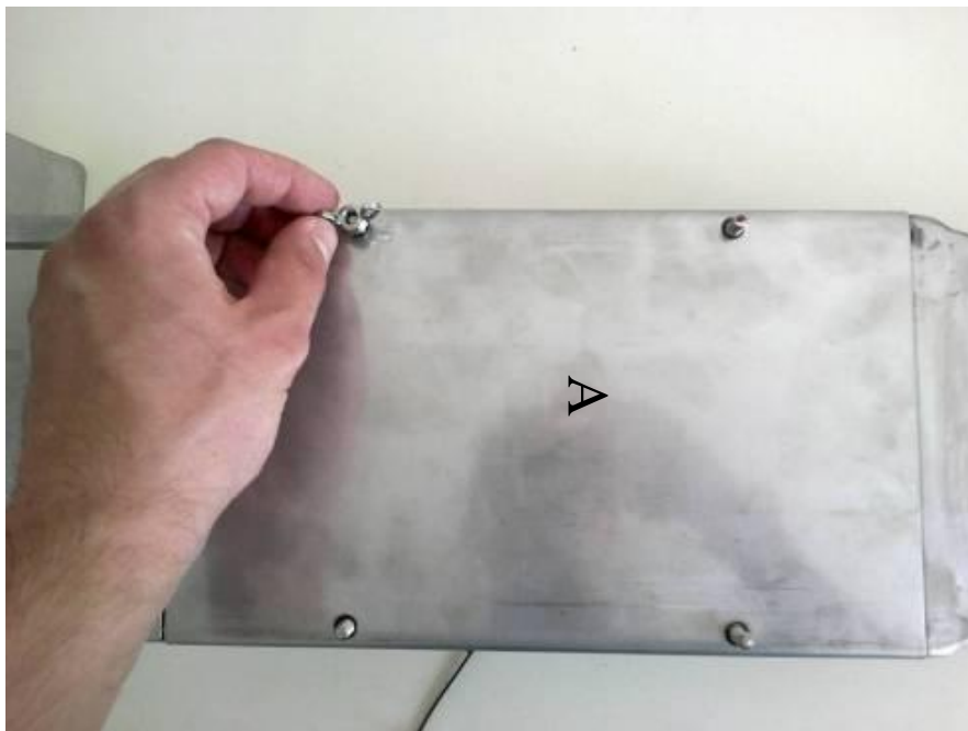
Obrázek 14 Otevírání a uzavírání víka vzorkovacího zařízení při manipulaci se vzorkovači.
