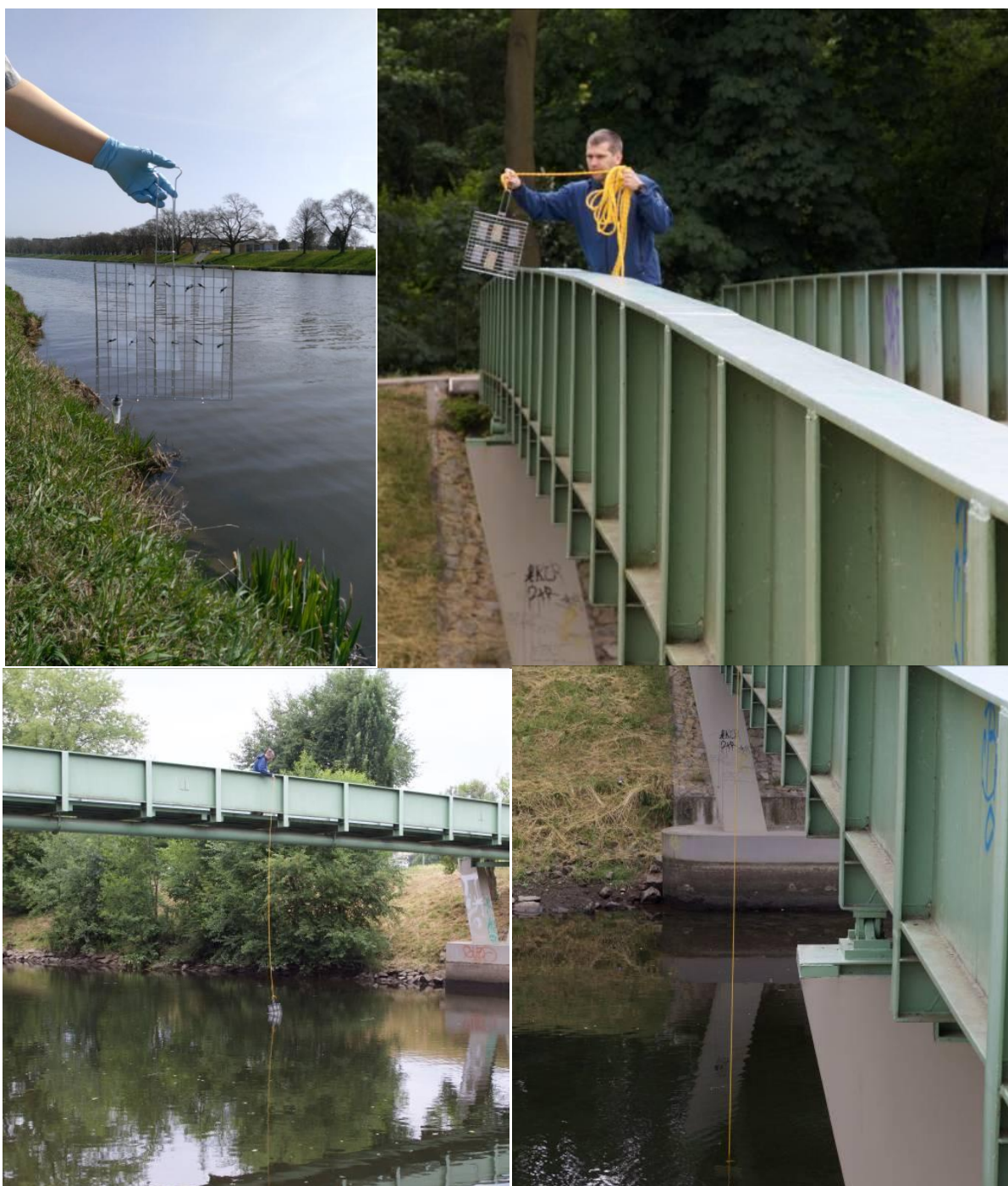
Obrázek 7 Příklad instalace vzorkovacího zařízení pro statickou expozici pasivních vzorkovačů v terénu.
