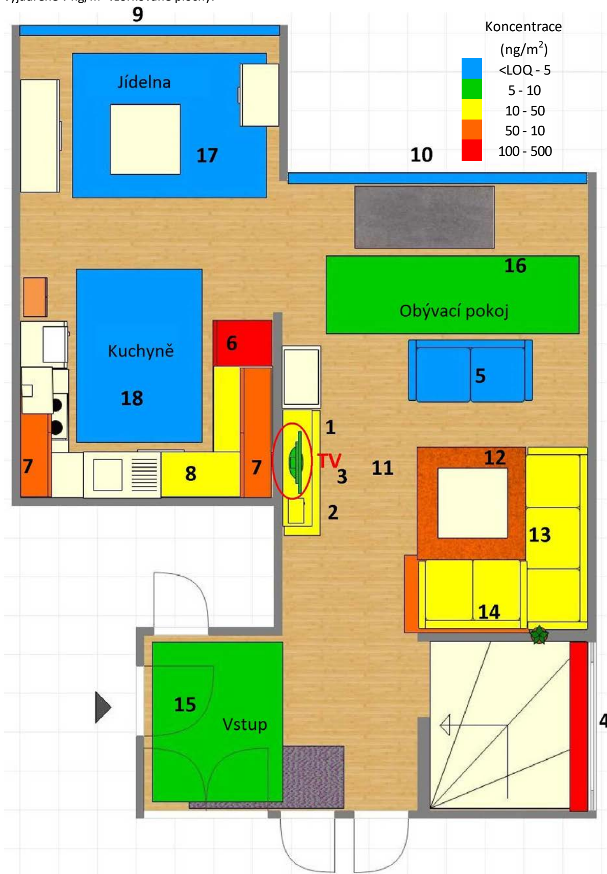
Mapa č. 54 Schéma rezidenčního bytu s barevnou koncentrační škálou BDE209 ve vzorcích prachu vyjádřené v \text{ng}/\text{m}^2 vzorkované plochy.
