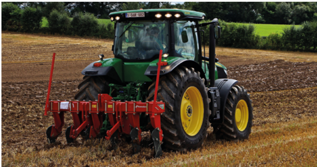
Obr. 1-26. Půdoochranná technologie podrývání
