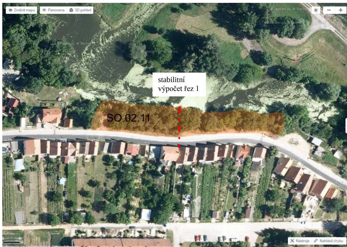
Obr. 22. Přehledná situace sesuvného svahu s vykreslením stabilitního řezu v profilu 1 (Mašín 2016).
