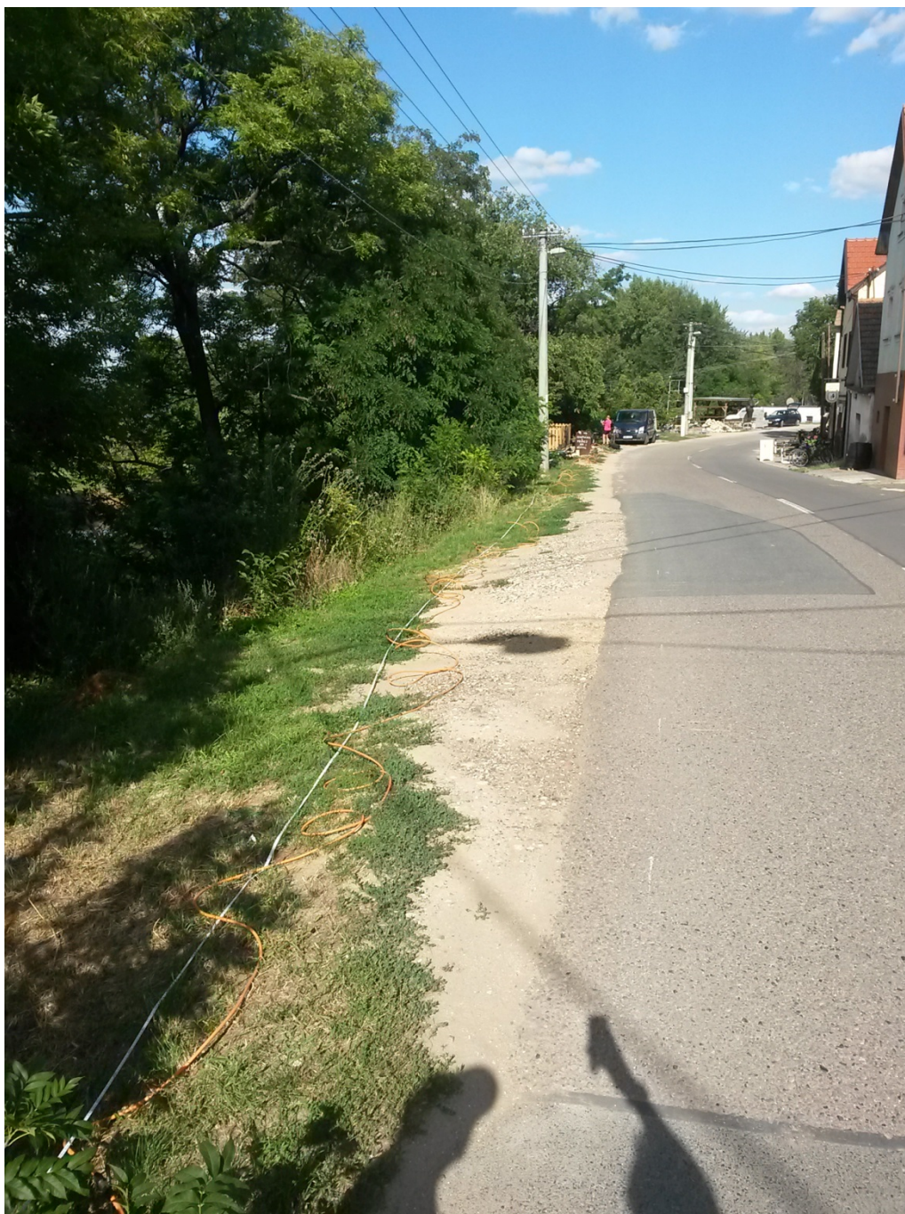
Foto 14: Měření metodou ERT na profilu P2. Foto: P. Kycl 07.07.2016.
