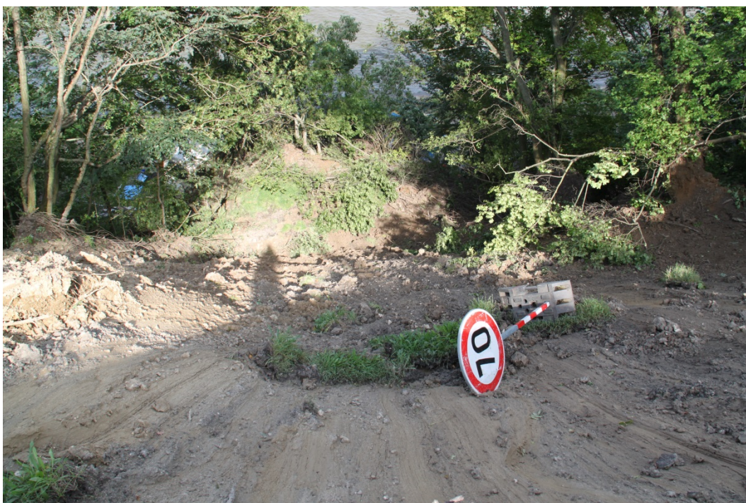
Foto 2: Pohled z odlučné hrany na akumulční část sesuvu č. 1a 1 v Dolních Věstonicích. Foto: R. Novotný, 15.09.2014.
