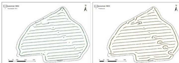
Obrázek 7: Způsob objíždění vnitřních překážek při aplikaci granulovaných minerálních hnojiv rozmetadlem (vlevo) a vpravo při aplikaci kapalných látek postřikovačem (zpracoval Kroulík).
