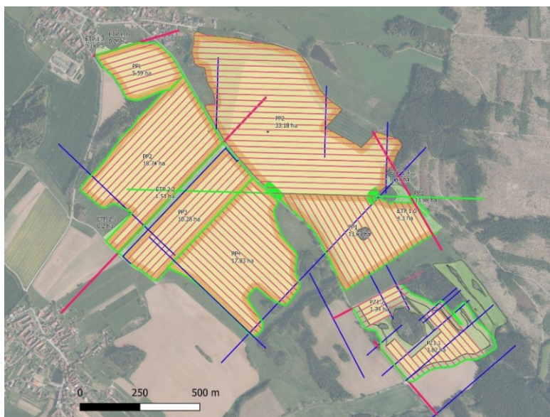
Obrázek 64: Postup tvorby zonace jednotlivých DPB na základě násobků šířky pojezdů. (Růžová je výchozí linie, modrá je kolmá linie na výchozí, zelená je pomocná linie, či linie souvratě, červené linie jsou násobky pojezdu zemědělské techniky. Žluté plochy PP a zelené plochy ETP).
