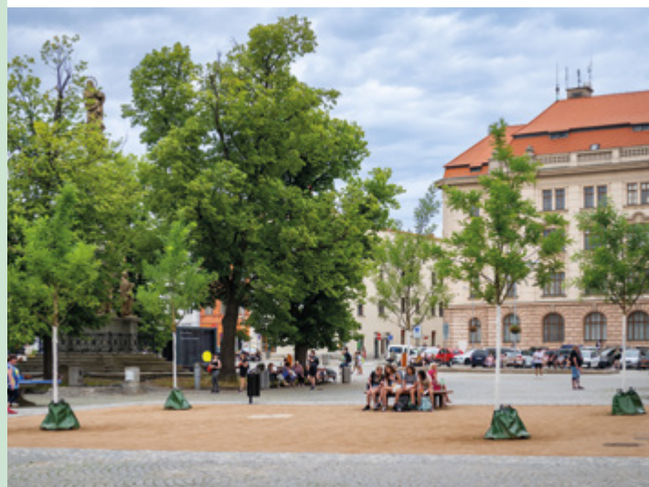
Výsadby dřevin do strukturálního substrátu v Jihlavě a zavlažovací vaky pomáhají stromům přežít nepříznivé podmínky v zastavěném území a lépe poskytovat ekosystémové služby. Foto: Nadace Partnerství, Vojta Herout
