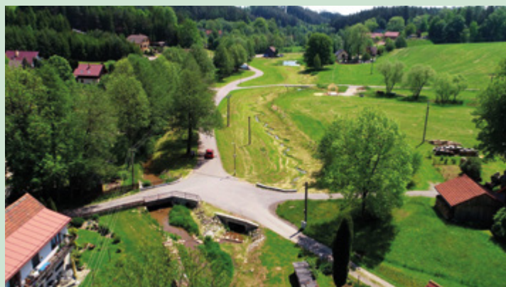
Přírodě blízká protipovodňová opatření v Písečné – odlehčovací koryto s kapacitnějším propustkem a přírodním tokem. Foto: Envicons
