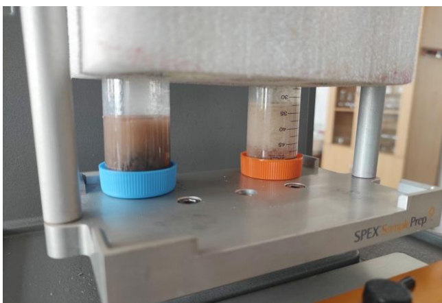
Obr. 14: Vzorek ledvin (vlevo) a vnitřního tuku (vpravo) zajíců po přidání acetonitrilu, destilované vody a po jeho vytřepání na vertikální třepačce. (foto: Eva Eiglová)
