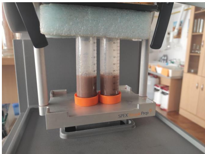
Obr. 12: Vzorek jater hlodavců po přidání acetonitrilu, destilované vody a po jeho vytřepání na vertikální třepačce. (foto: Eva Eiglová)
