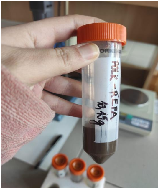
Obr. 8: Vzorek půdy po přidání acetonitrilu a 1% kyseliny mravenčí. (foto: Eva Eiglová)
