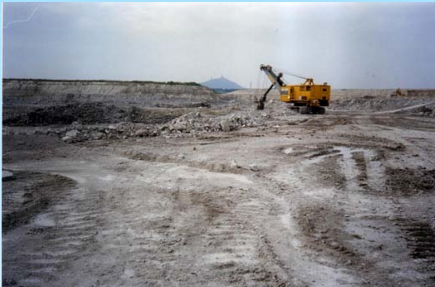
Příklad těžby nerudných surovin, ovlivňující tvárnost krajiny. Křídové slínovce z Čížkovic u Lovosic jsou využívány v cementářenském průmyslu. V pozadí hrad Hazmburk. Foto F.Reichmann.
