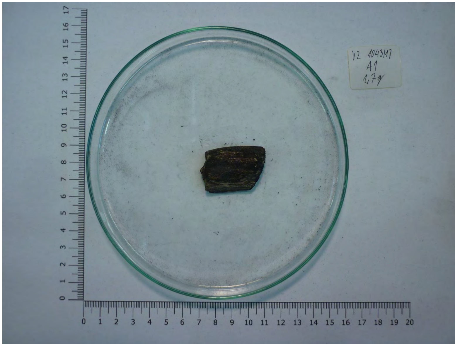
Obrázek 2.1.12-2 Nadsítná část celého vzorku (> 16 mm)
