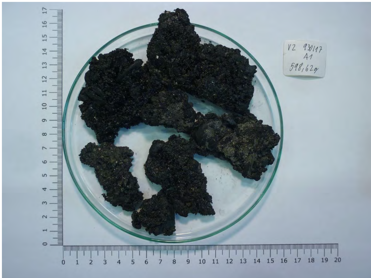
Obrázek 3.1.2-2 Nadsítná část celého vzorku (> 16 mm)
