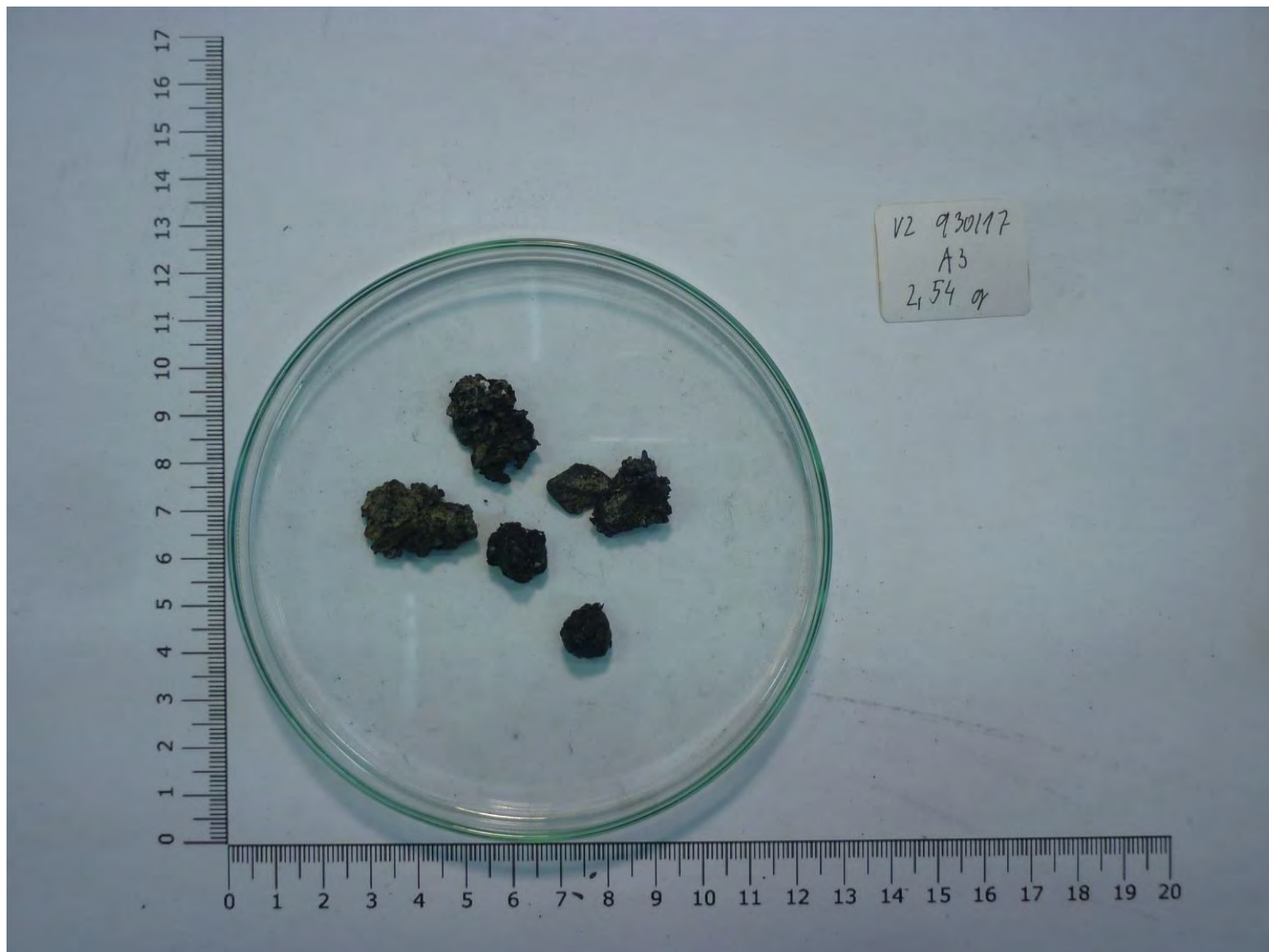
Obrázek 3.1.2-4 Cizí příměsi odhalené při vizuální kontrole
