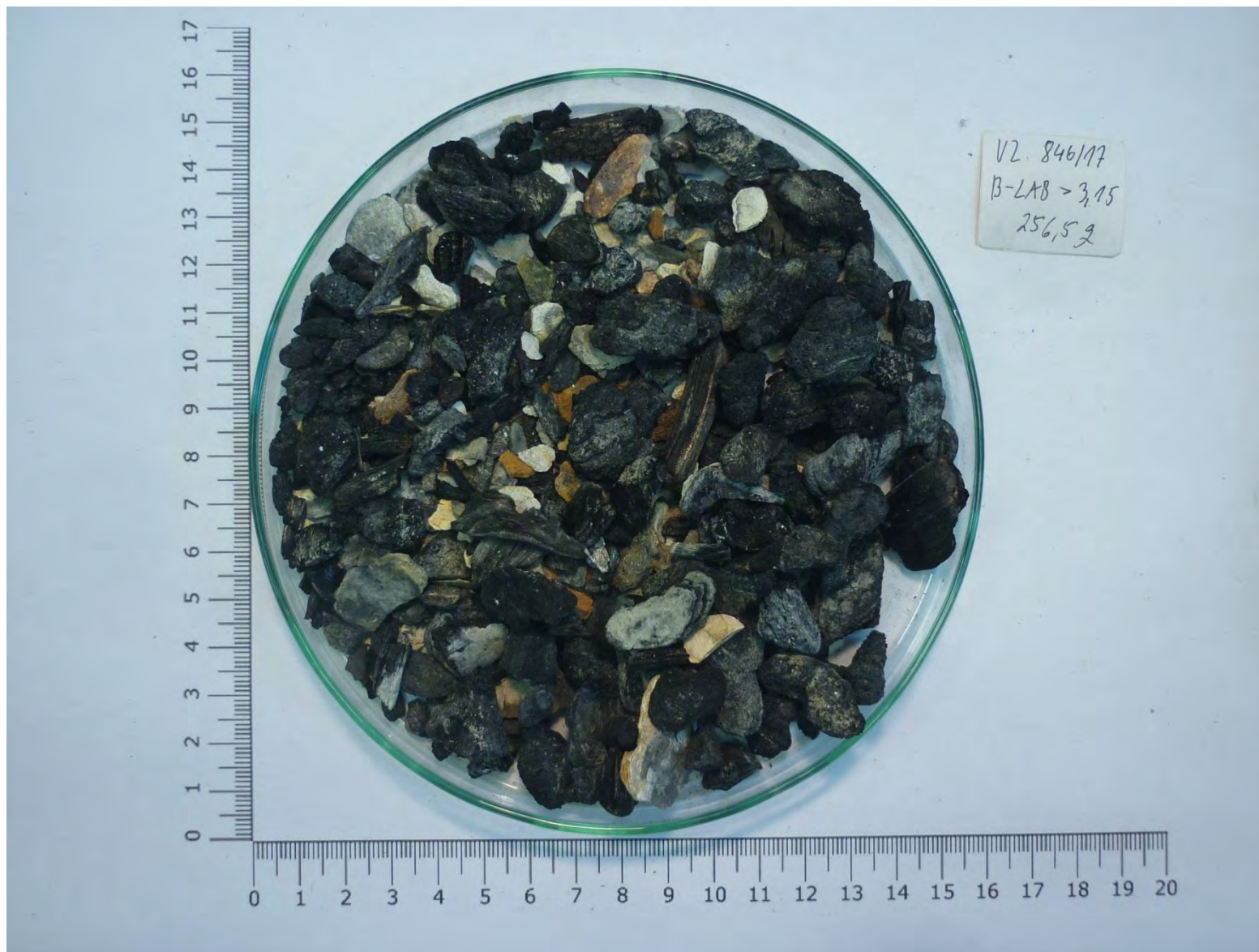
Obrázek 3.6.4-5 Reprezentativní část laboratorního vzorku (> 3,15 mm)
