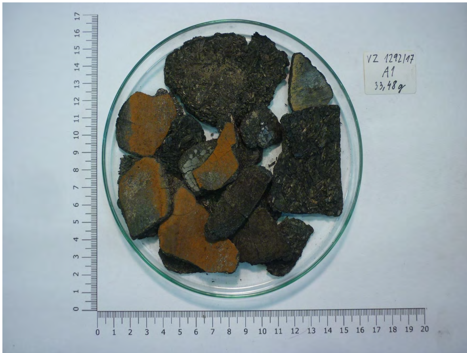
Obrázek 3.7.3-2 Nadsítná část celého vzorku (> 16 mm)
