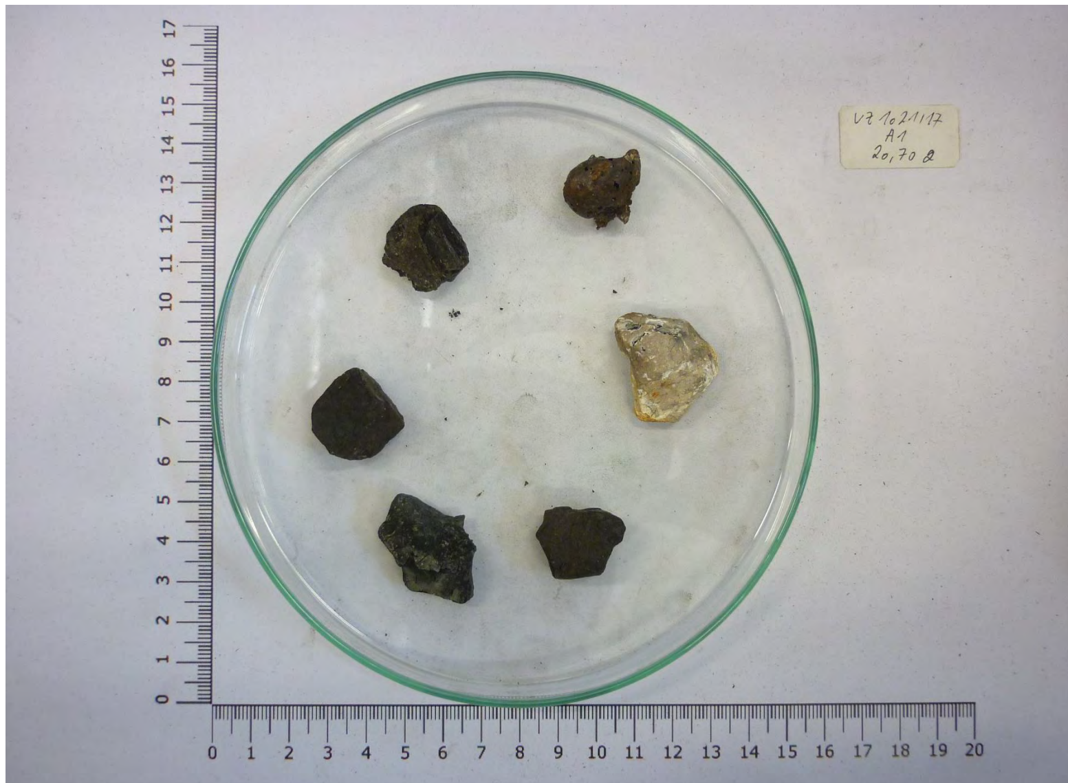
Obrázek 4.1.1-2 Nadsítná část celého vzorku (> 16 mm)
