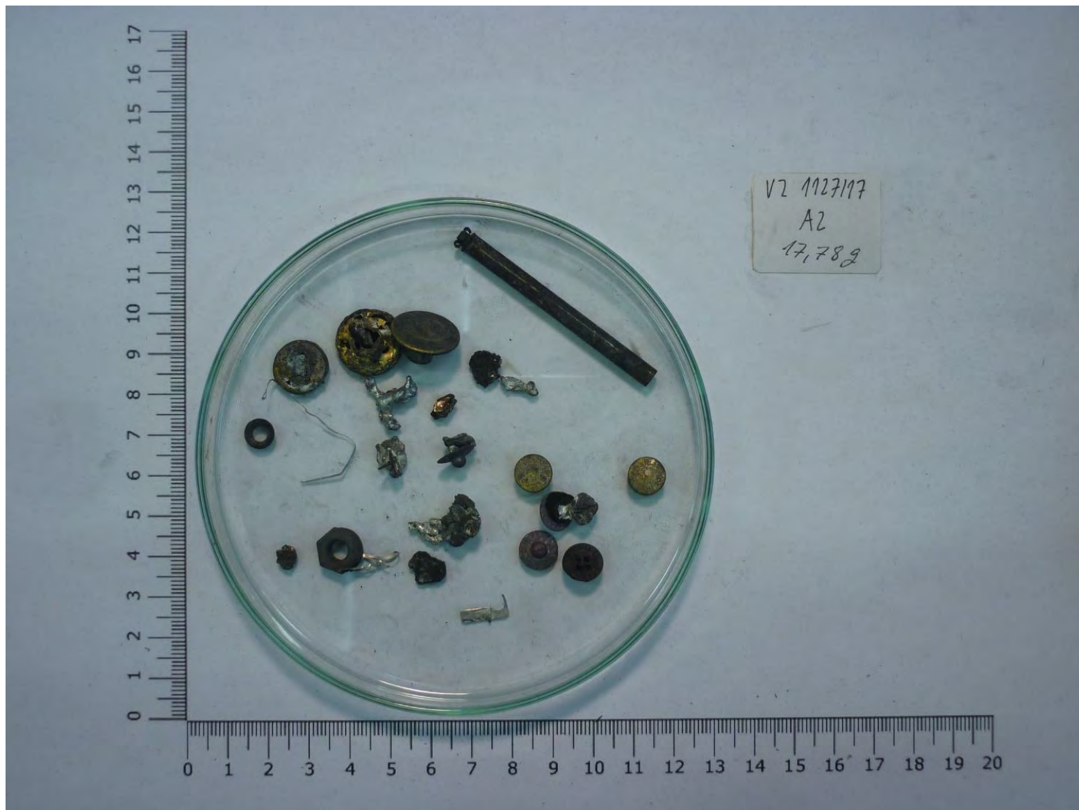
Obrázek 3.2.2-3 Inertní materiály odhalené při vizuální kontrole
