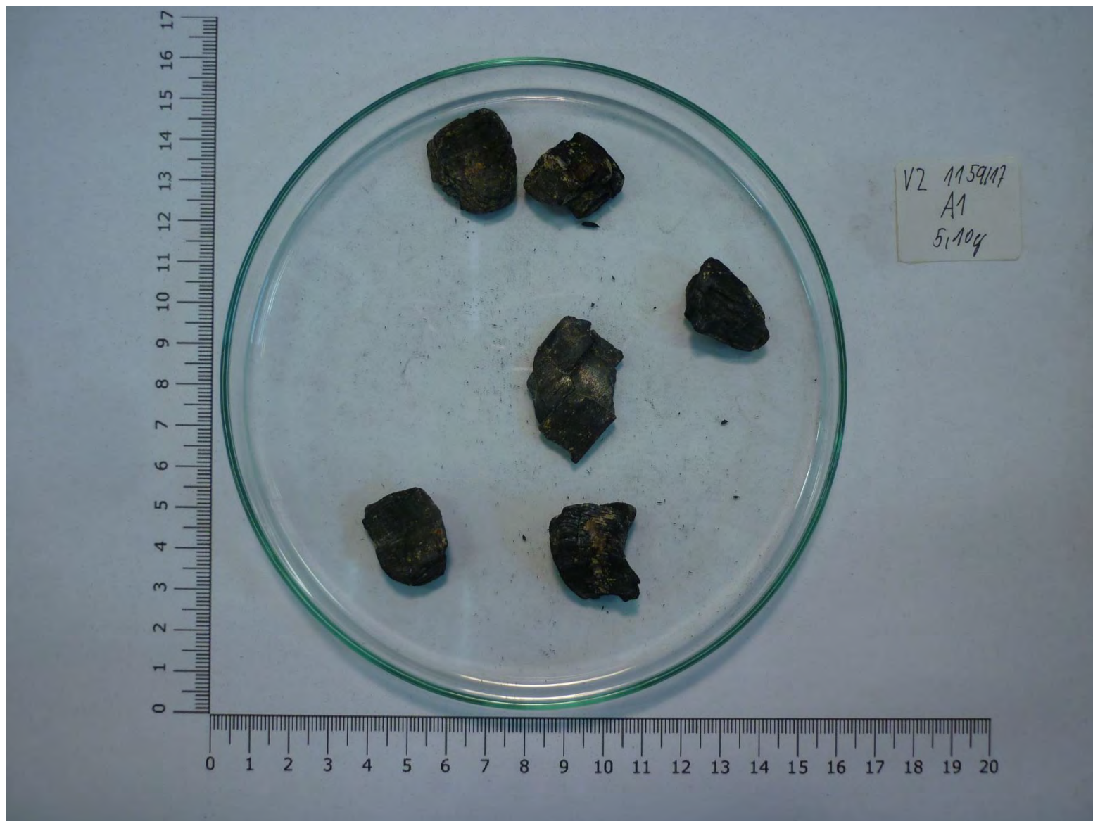
Obrázek 2.1.6-2 Nadsítná část celého vzorku (> 16 mm)
