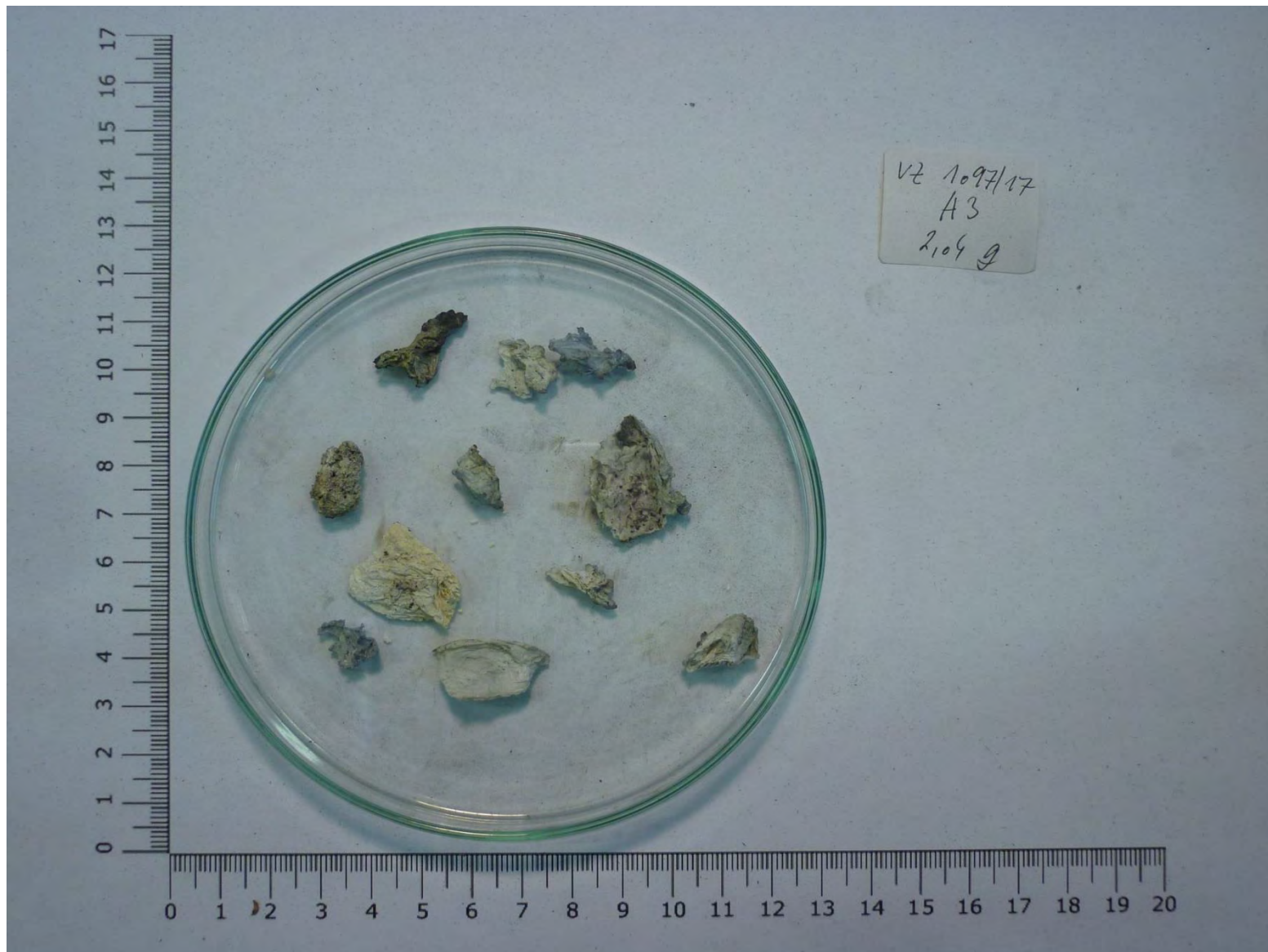
Obrázek 3.4.3-3 Cizí příměsi odhalené při vizuální kontrole
