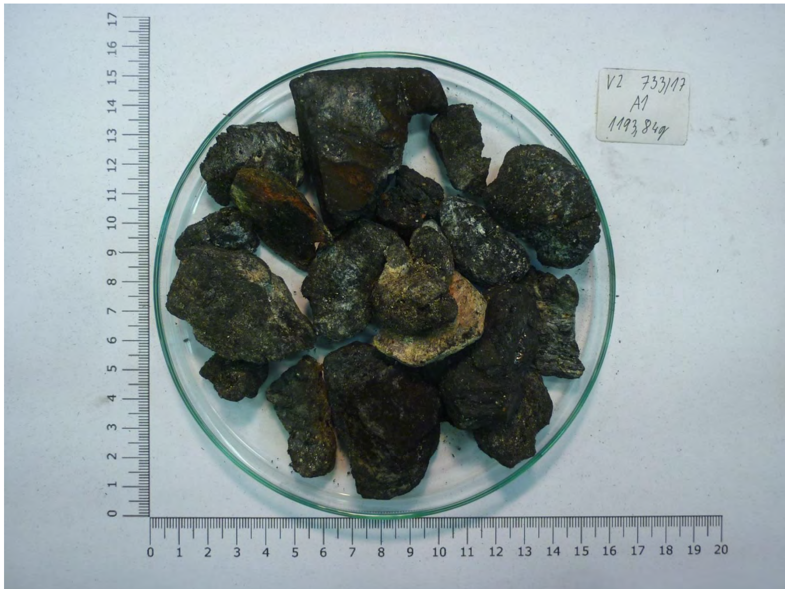
Obrázek 3.5.3-1 Nadsítná část celého vzorku (> 16 mm)
