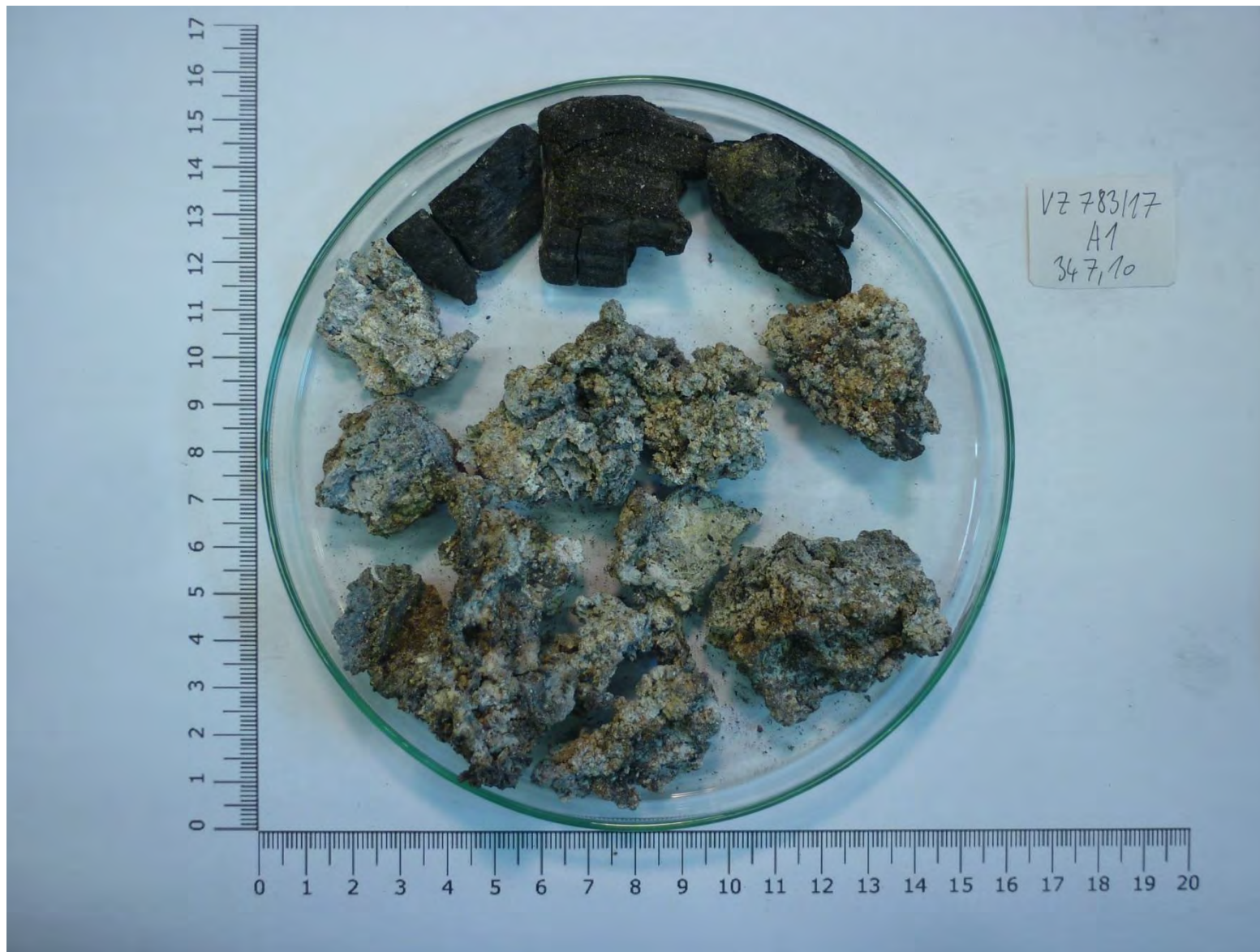
Obrázek 3.5.1-2 Nadsítná část celého vzorku (> 16 mm)
