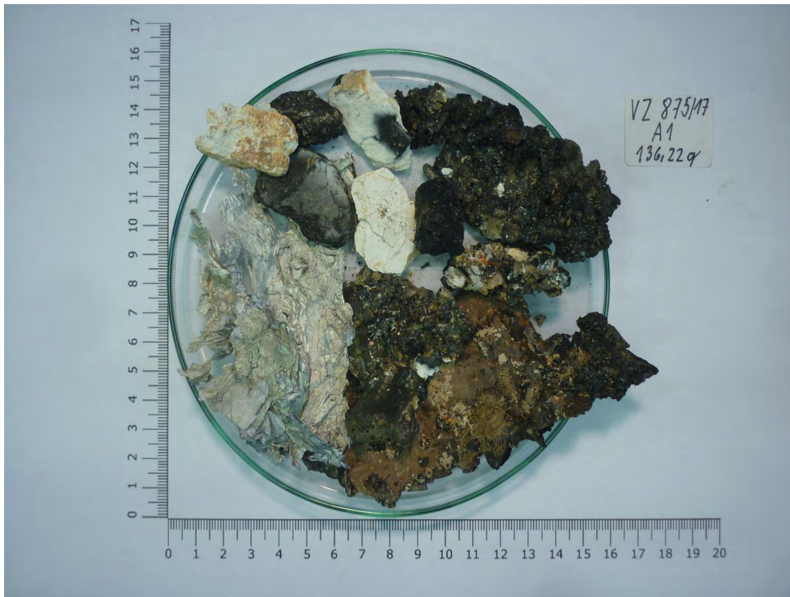
Obrázek 3.6.5-2 Nadsítná část celého vzorku (> 16 mm)
