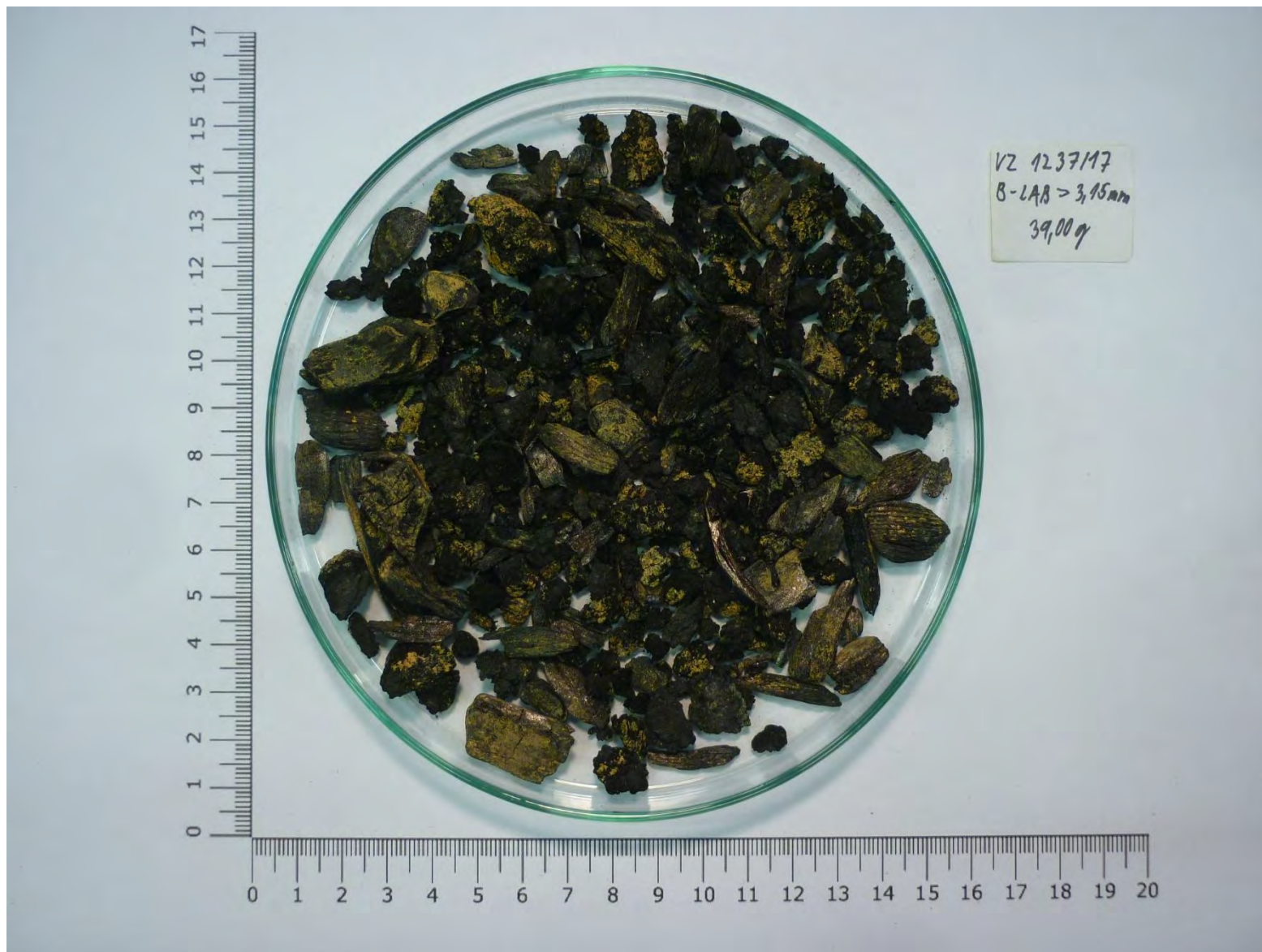
Obrázek 2.3.3-4 Reprezentativní část laboratorního vzorku (> 3,15 mm)
