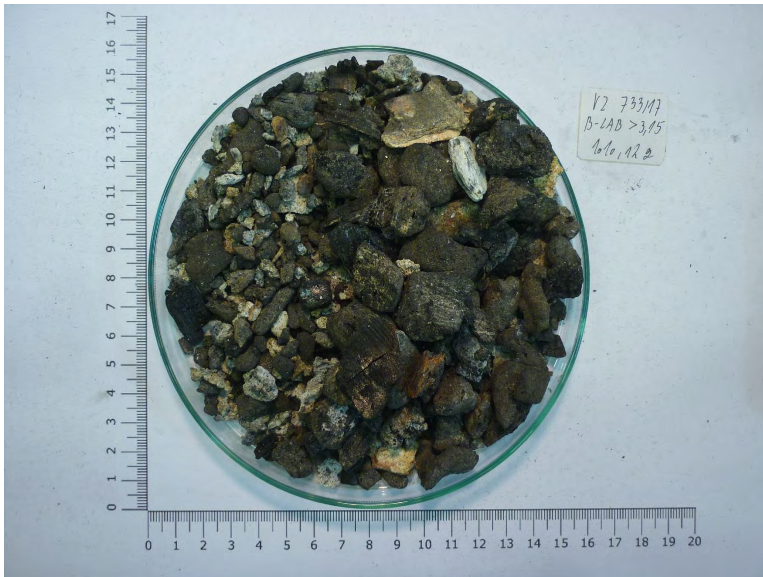
Obrázek 3.5.3-4 Reprezentativní část laboratorního vzorku (> 3,15 mm)
