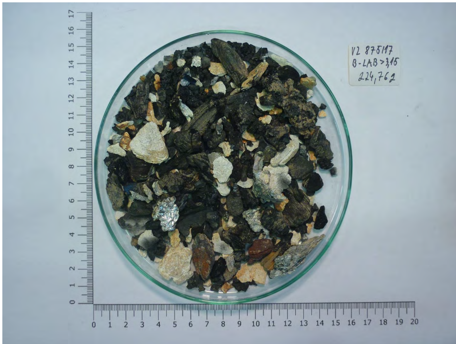
Obrázek 3.6.5-6 Reprezentativní část laboratorního vzorku (> 3,15 mm)
