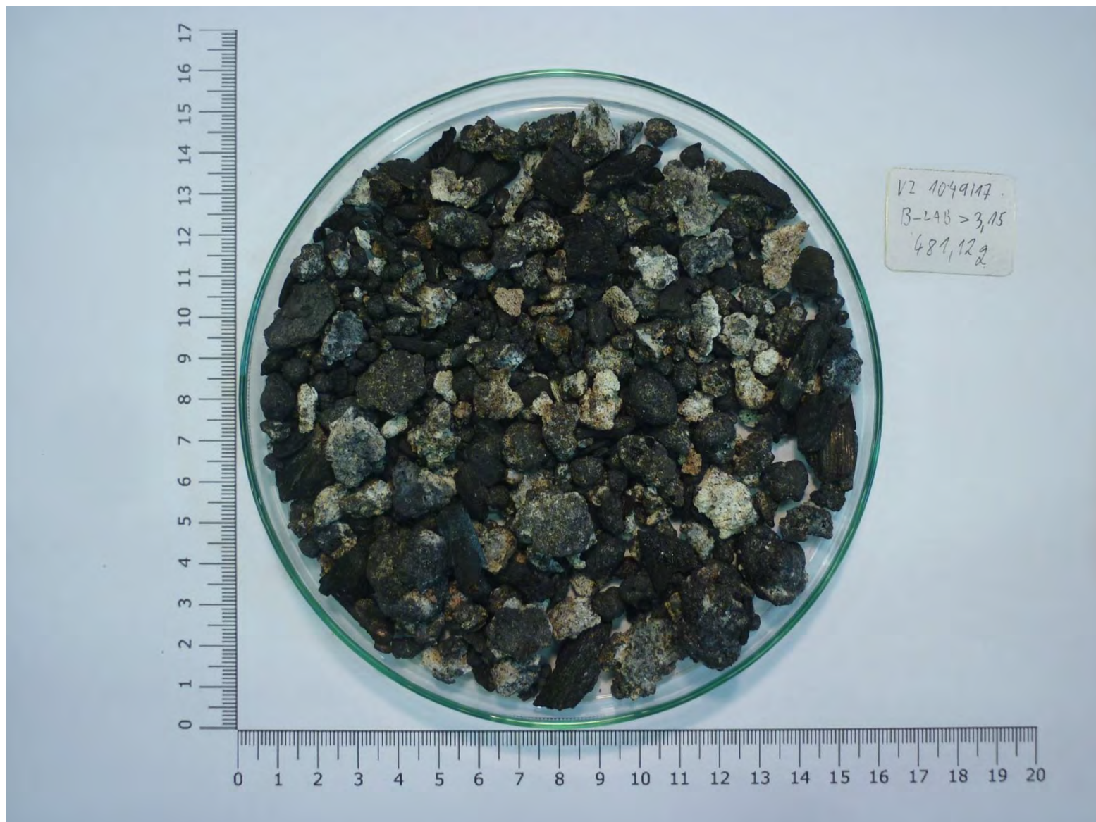
Obrázek 3.5.2-5 Reprezentativní část laboratorního vzorku (> 3,15 mm)
