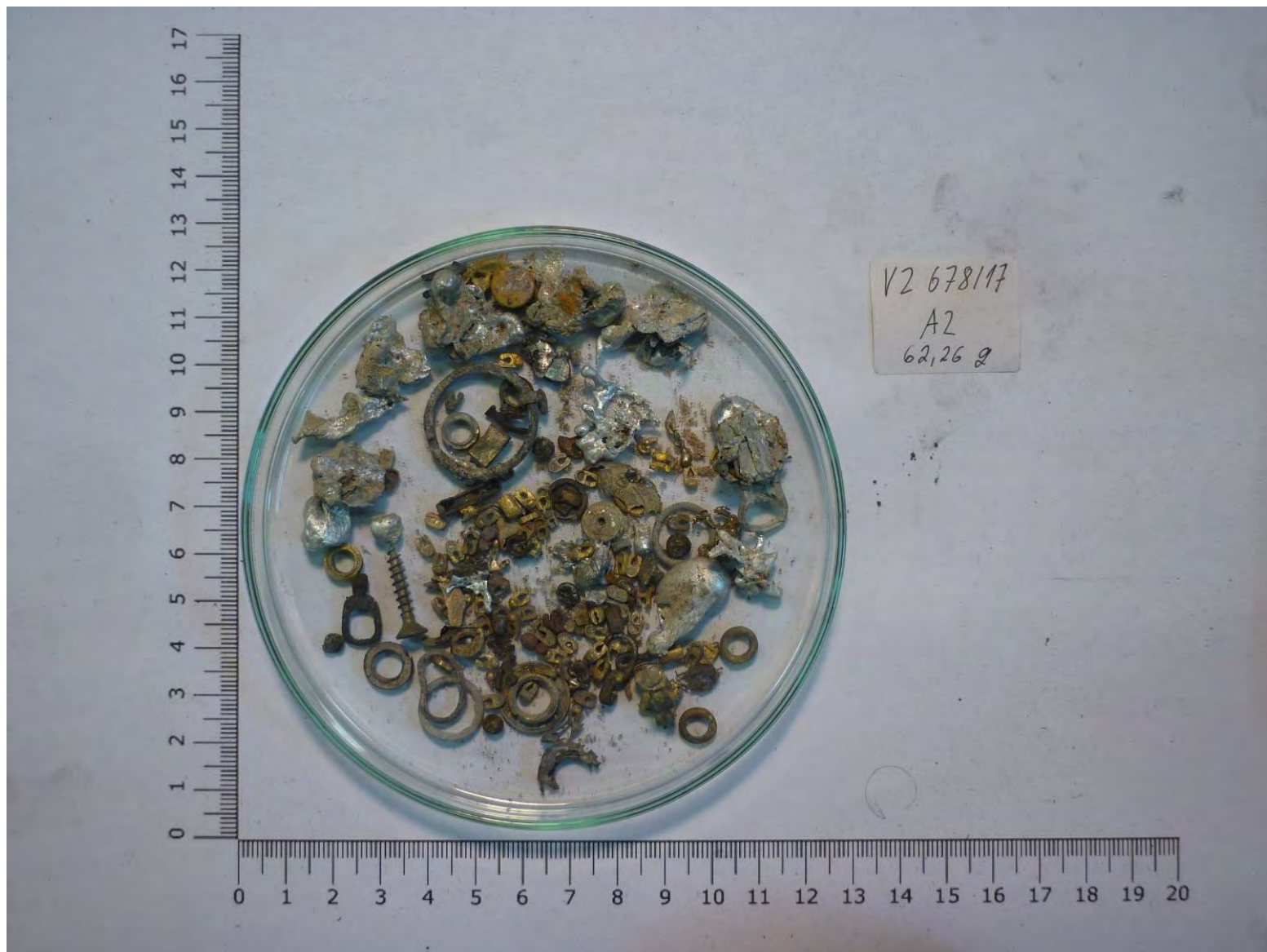
Obrázek 3.2.3-3 Inertní materiály odhalené při vizuální kontrole
