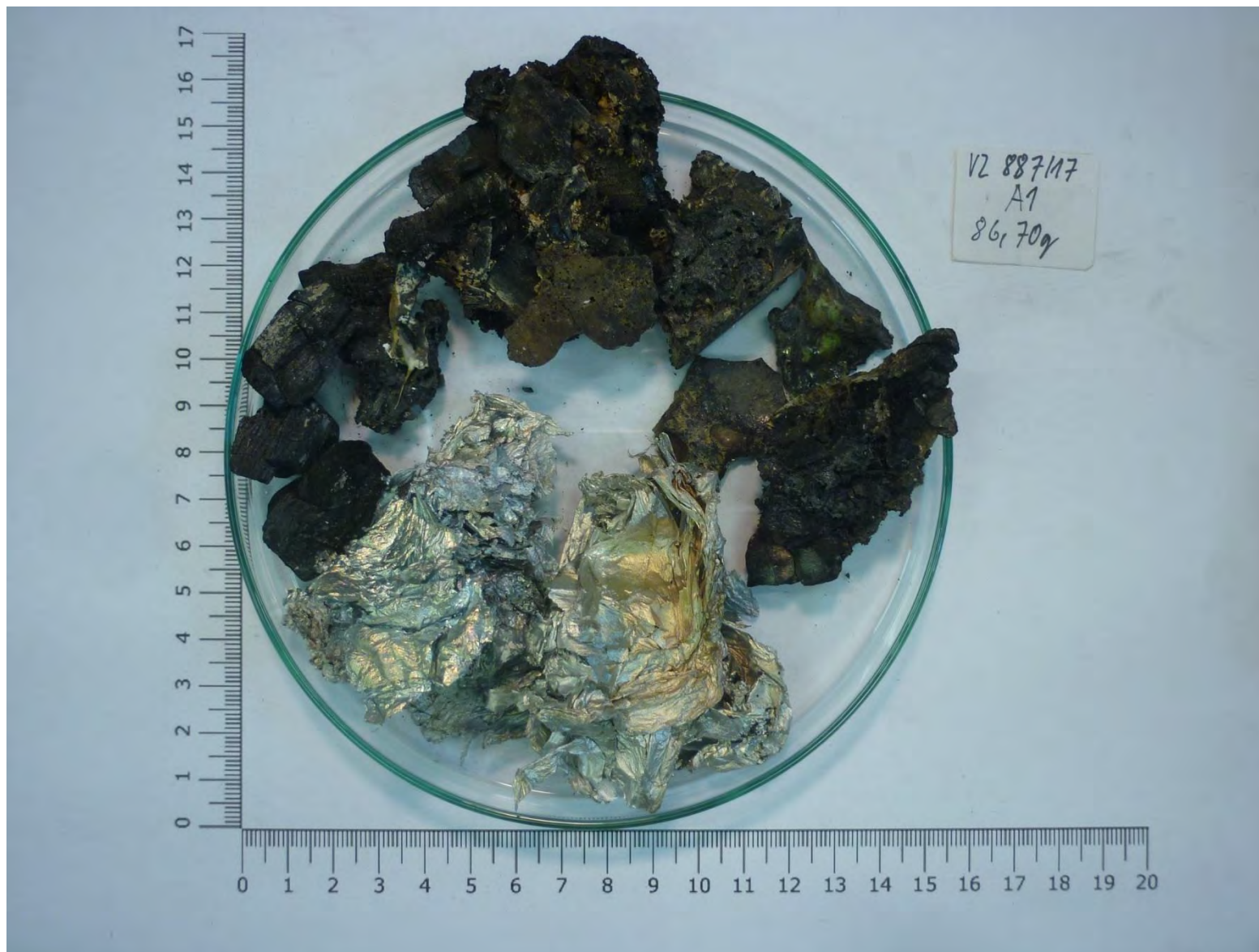
Obrázek 3.6.3-2 Nadsítná část celého vzorku (> 16 mm)
