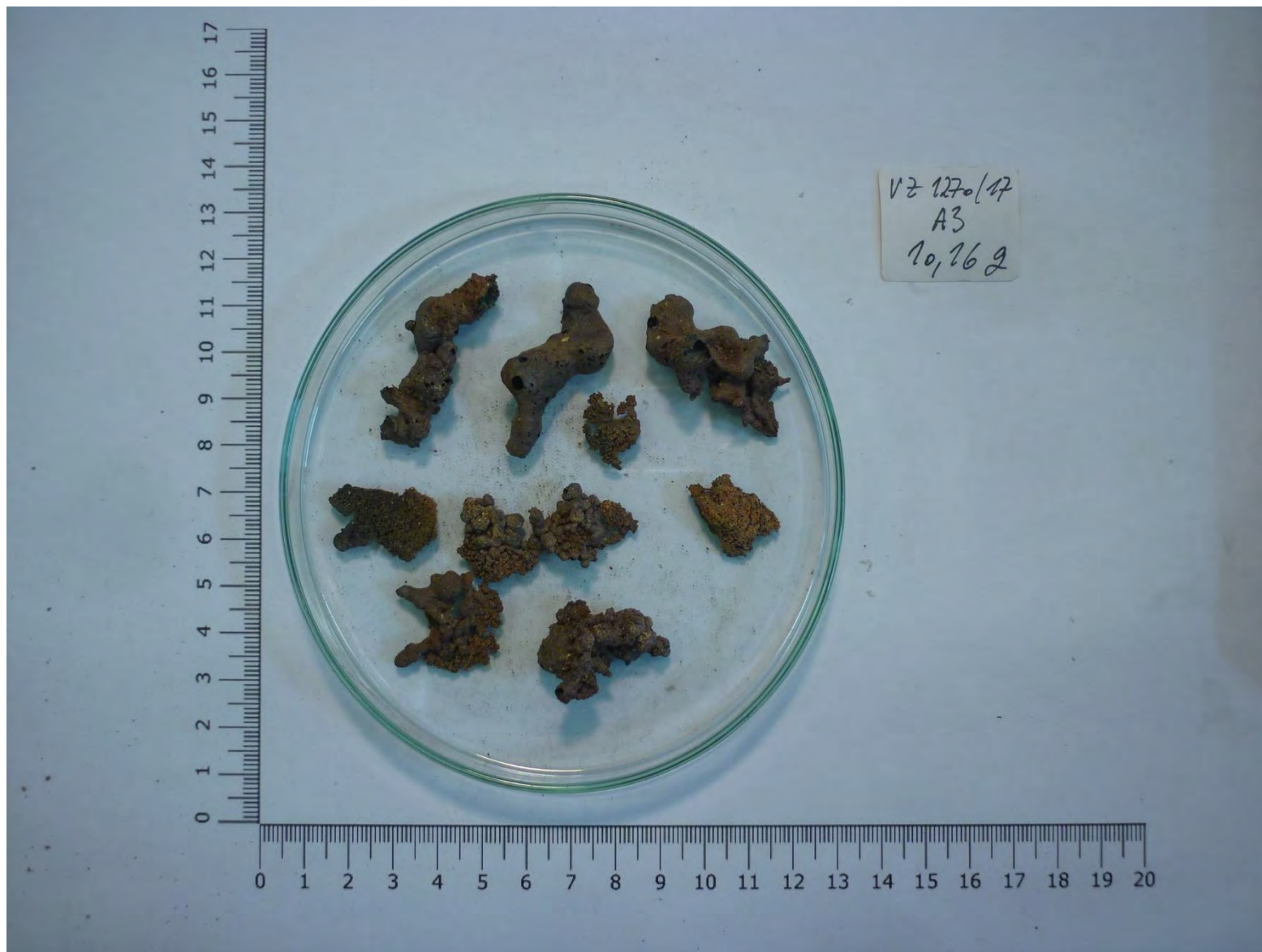
Obrázek 2.4.1-3 Cizí příměsi odhalené při vizuální kontrole
