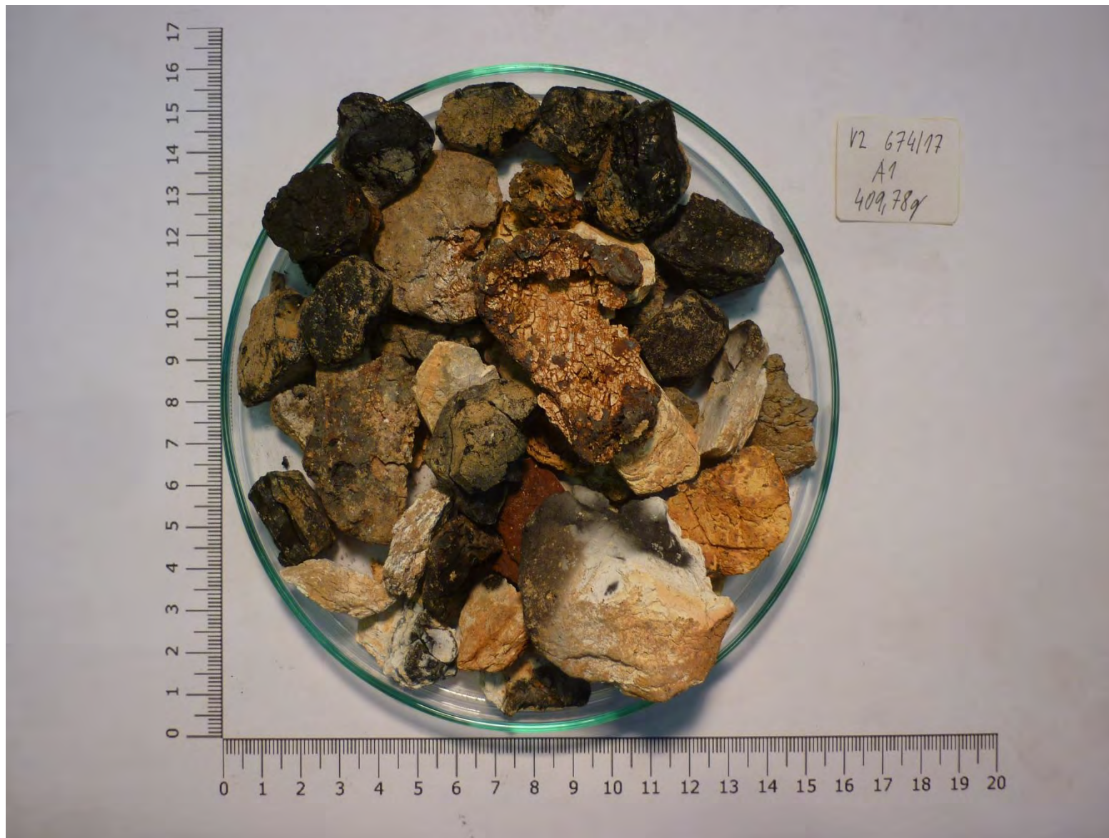
Obrázek 2.2.1-2 Nadsítná část celého vzorku (> 16 mm)
