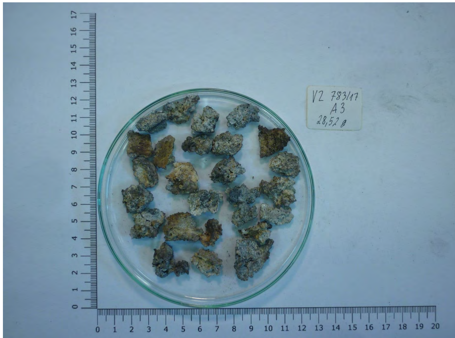
Obrázek 3.5.1-3 Cizí příměsi odhalené při vizuální kontrole
