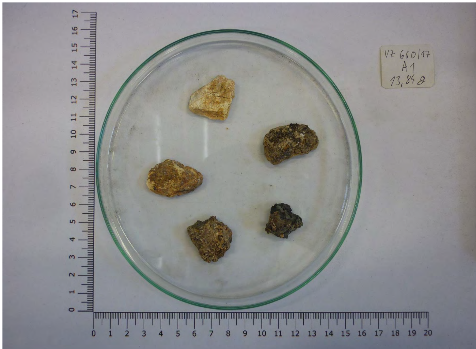
Obrázek 4.4.5-2 Nadsítná část celého vzorku (> 16 mm)
