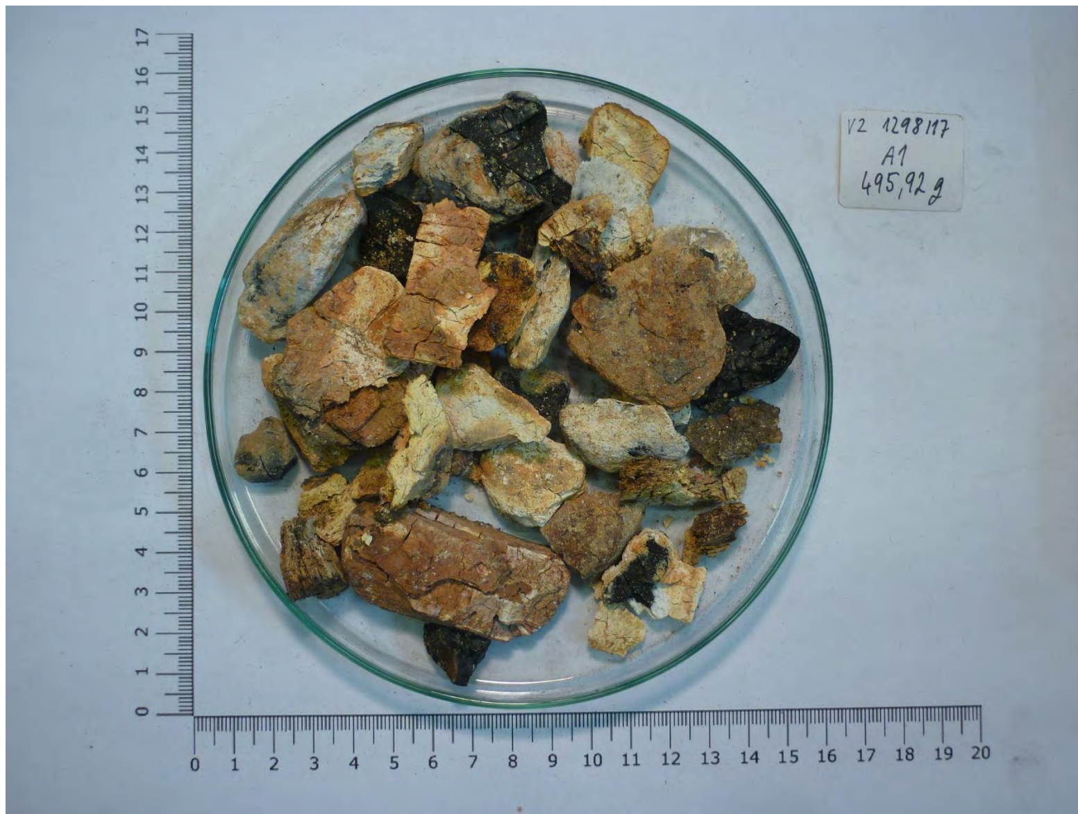
Obrázek 2.2.2-2 Nadsítná část celého vzorku (> 16 mm)
