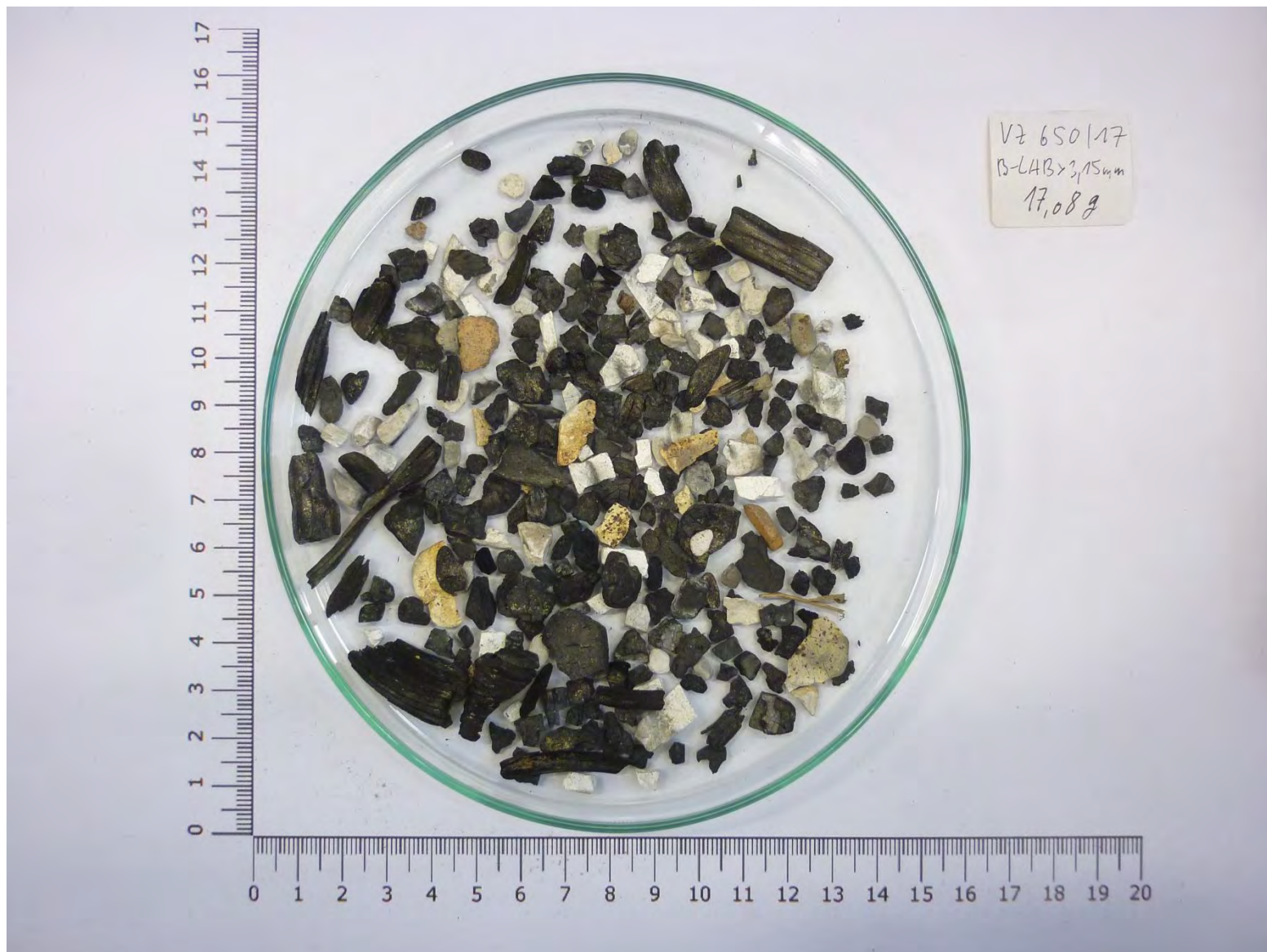
Obrázek 4.4.2-5 Reprezentativní část laboratorního vzorku (> 3,15 mm)
