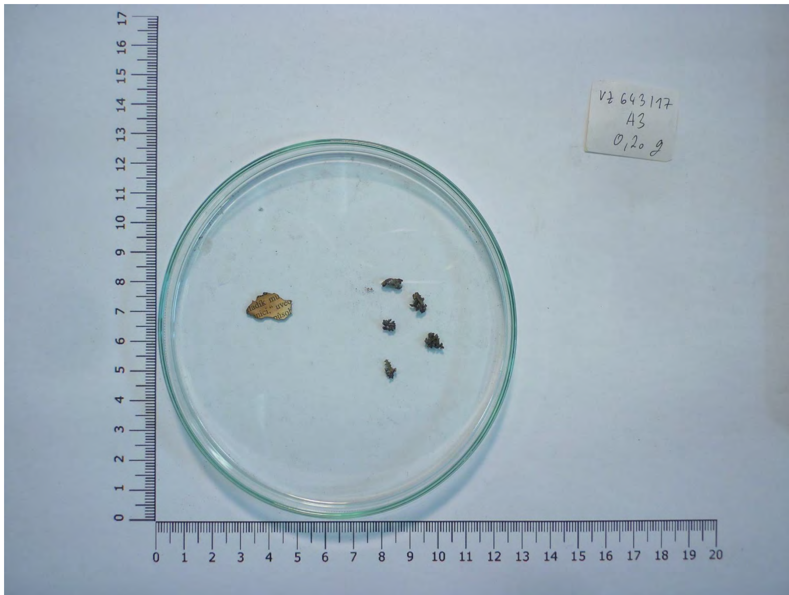
Obrázek 4.2.1-2 Cizí příměsi odhalené při vizuální kontrole
