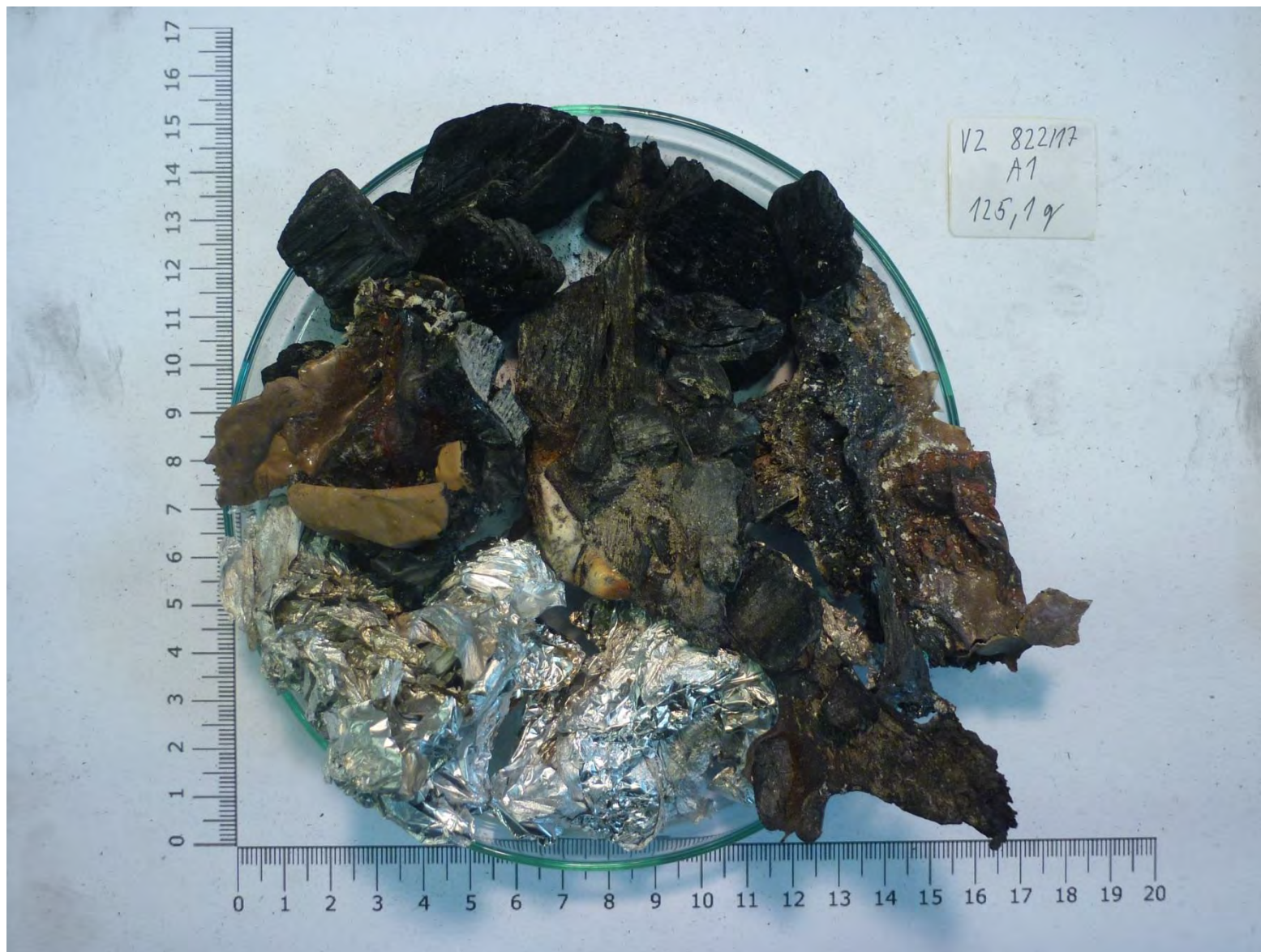
Obrázek 3.6.1-2 Nadsítná část celého vzorku (> 16 mm)
