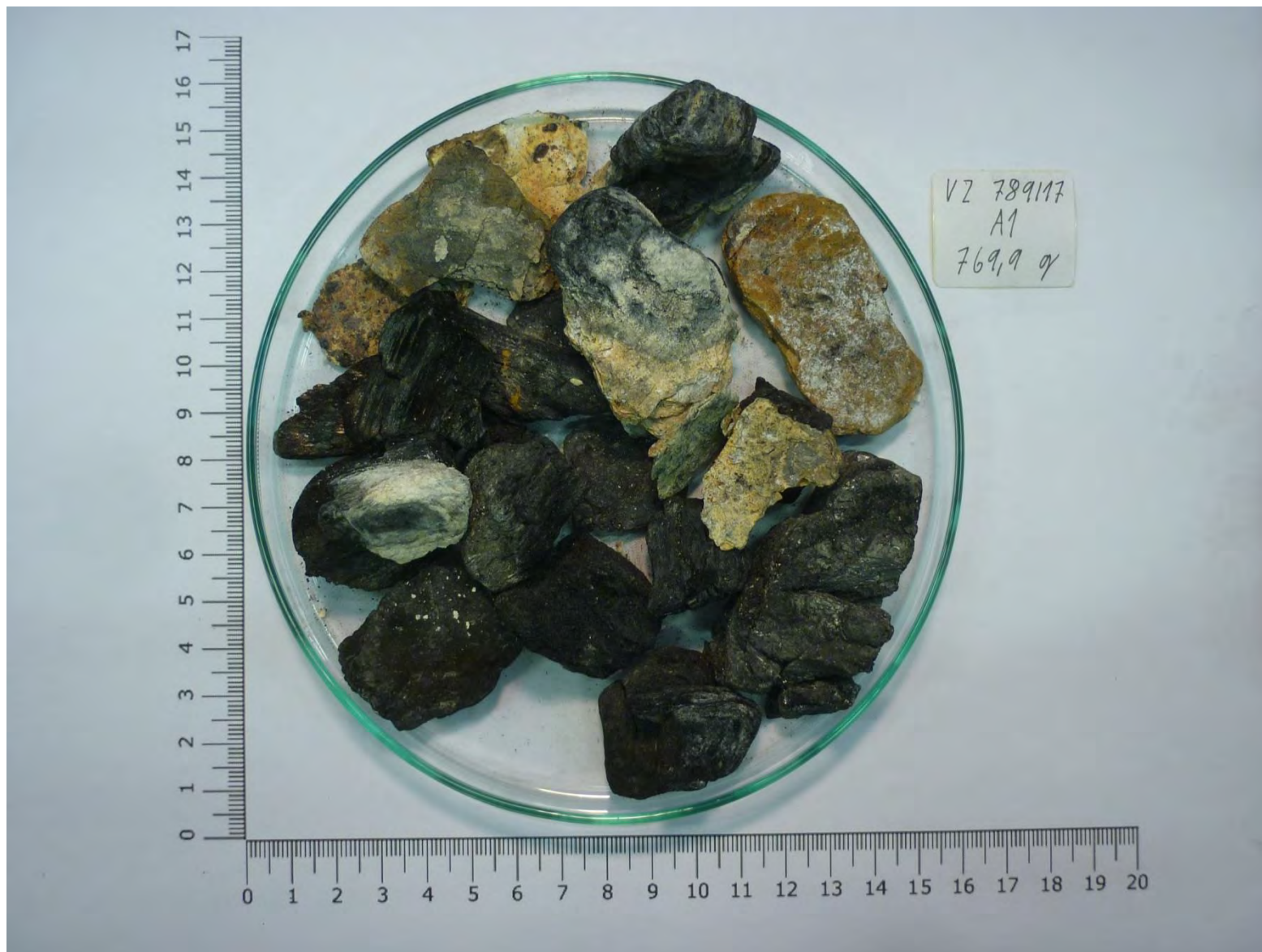
Obrázek 3.4.4-2 Nadsítná část celého vzorku (> 16 mm)
