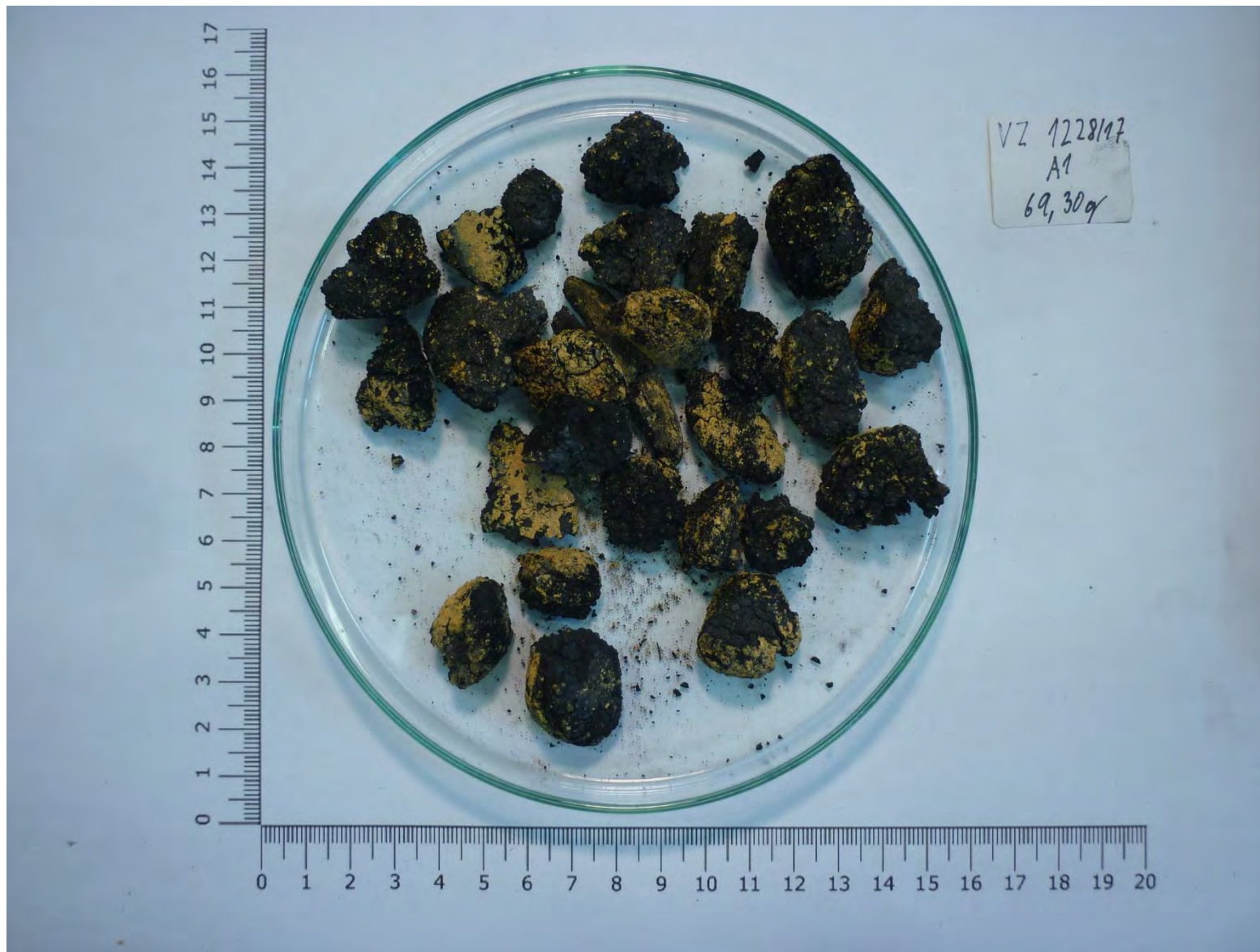
Obrázek 2.3.2-2 Nadsítná část celého vzorku (> 16 mm)
