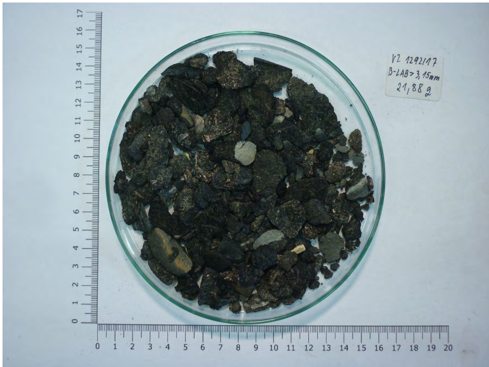
Obrázek 3.7.3-6 Reprezentativní část laboratorního vzorku (> 3,15 mm)
