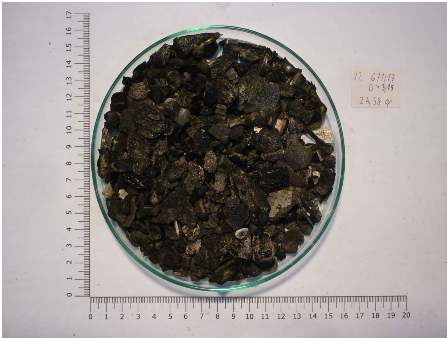
Obrázek 3.7.1-6 Reprezentativní část laboratorního vzorku ( > 3,15 mm)
