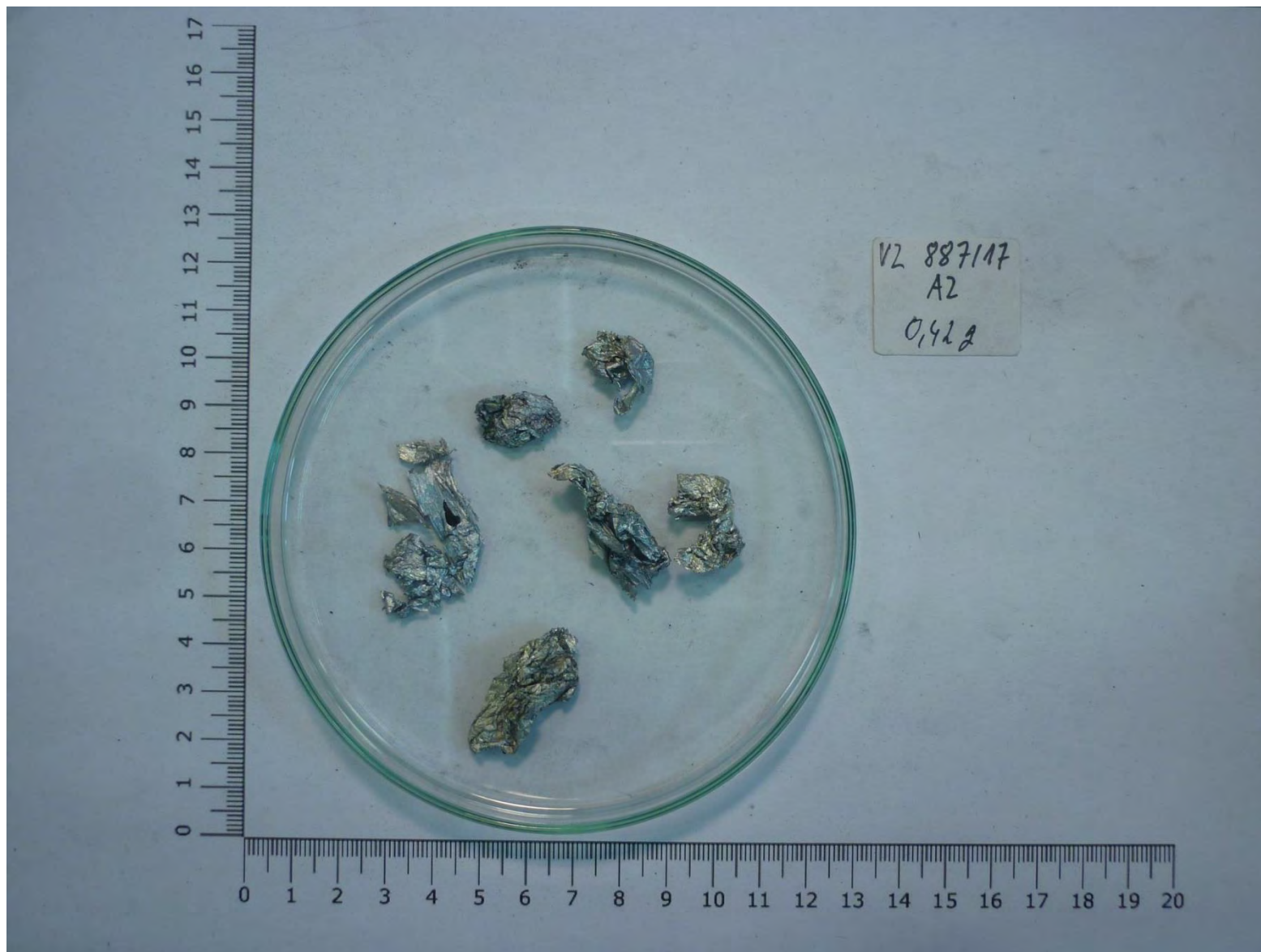
Obrázek 3.6.3-3 Inertní materiály odhalené při vizuální kontrole
