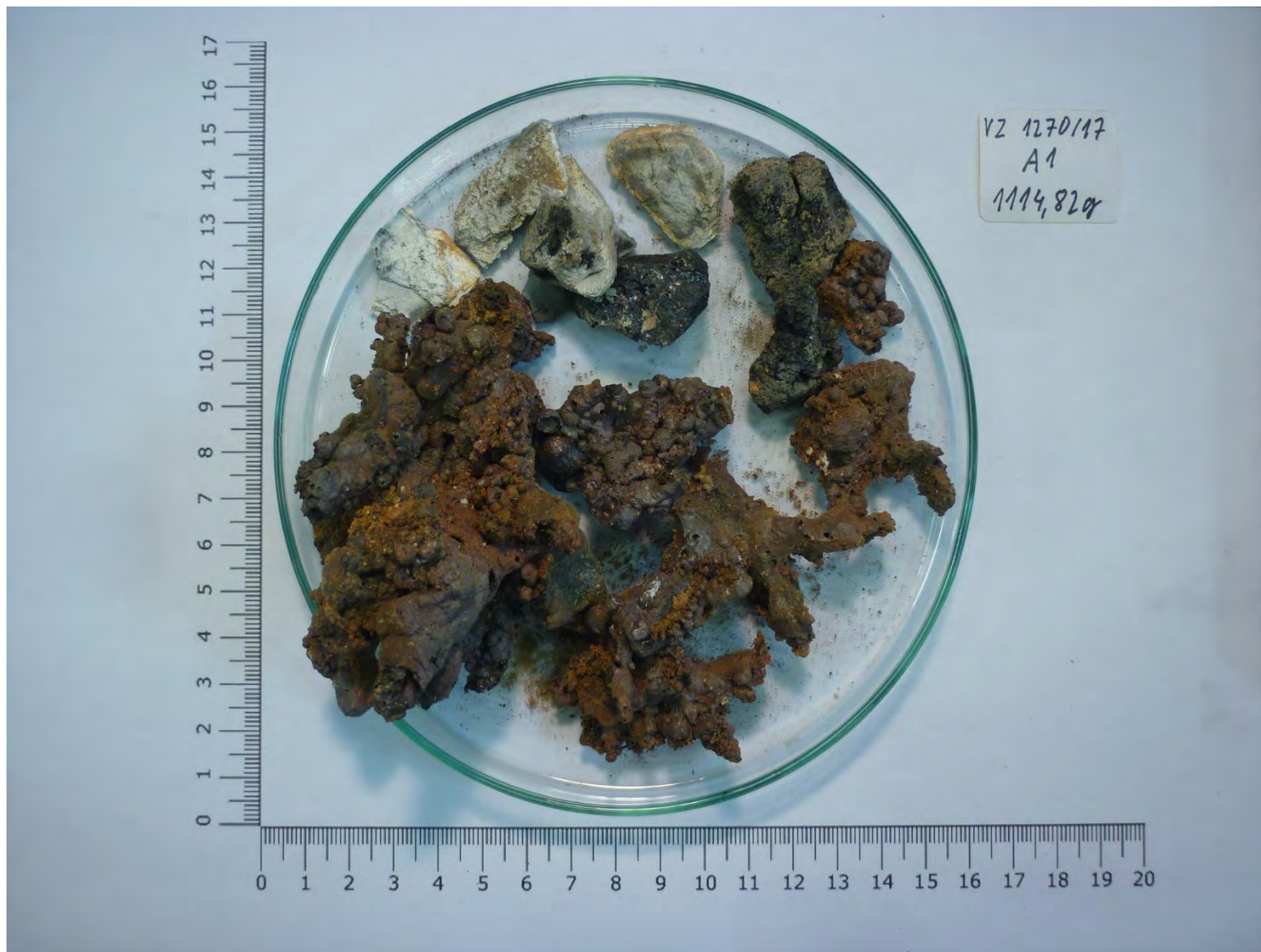
Obrázek 2.4.1-2 Nadsítná část celého vzorku (> 16 mm)
