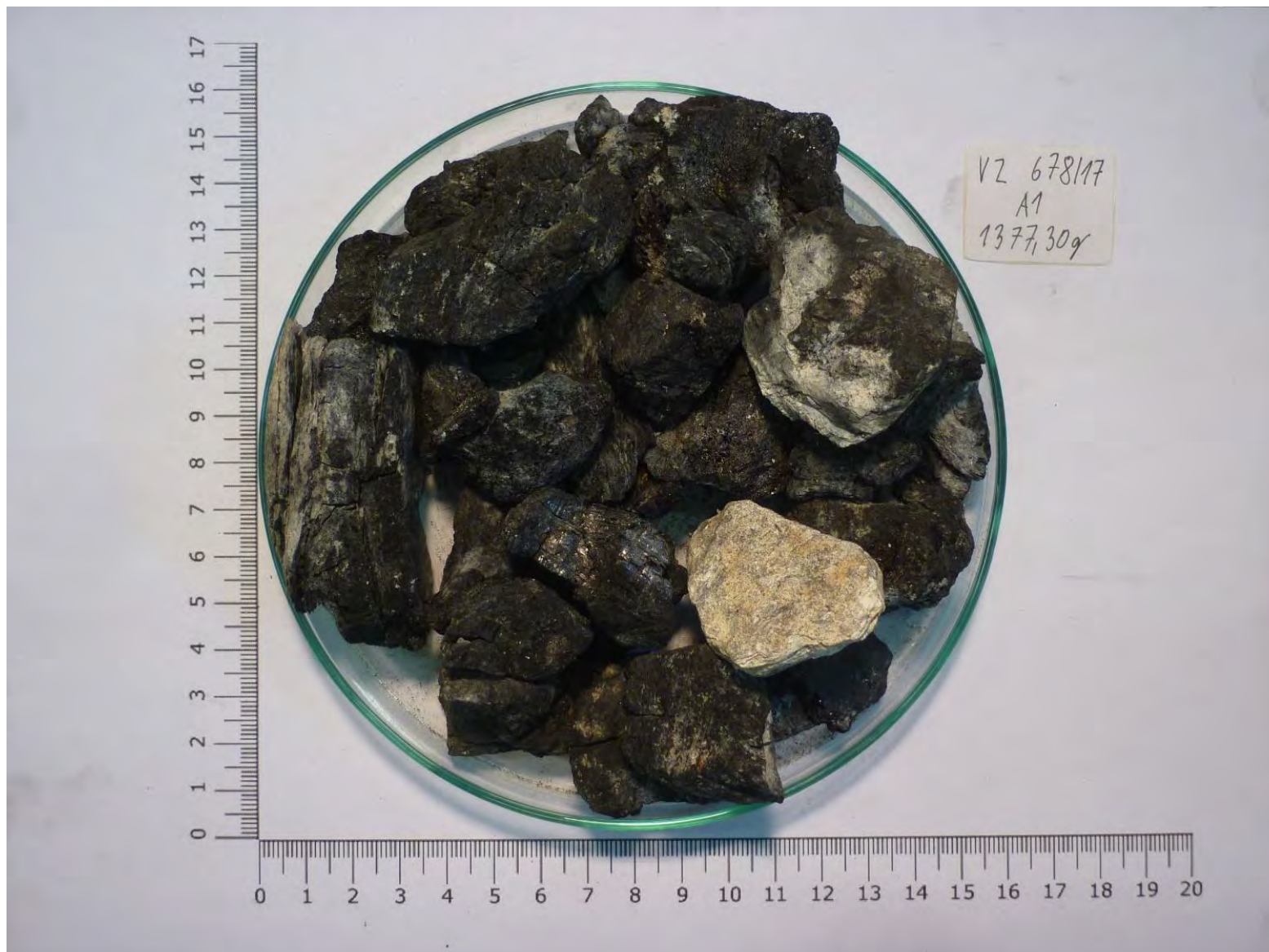
Obrázek 3.2.3-2 Nadsítná část celého vzorku (> 16 mm)
