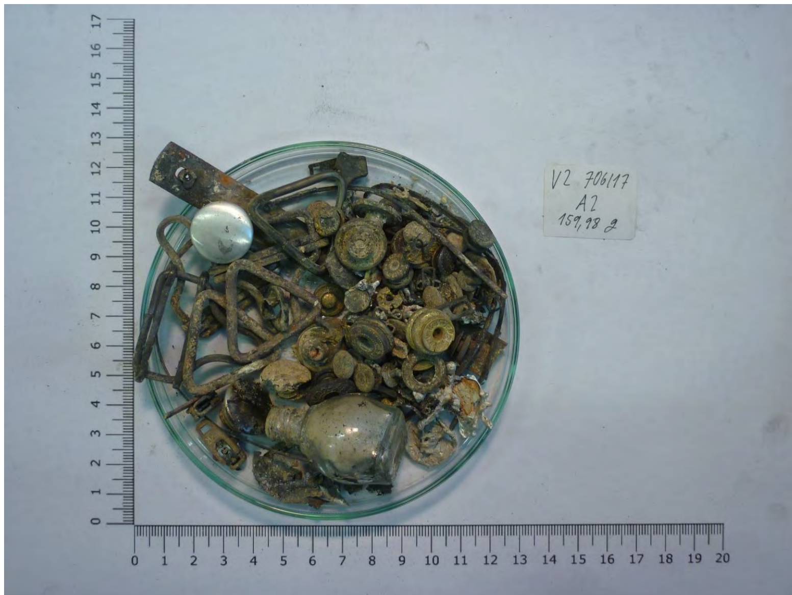
Obrázek 3.2.4-3 Inertní materiály odhalené při vizuální kontrole
