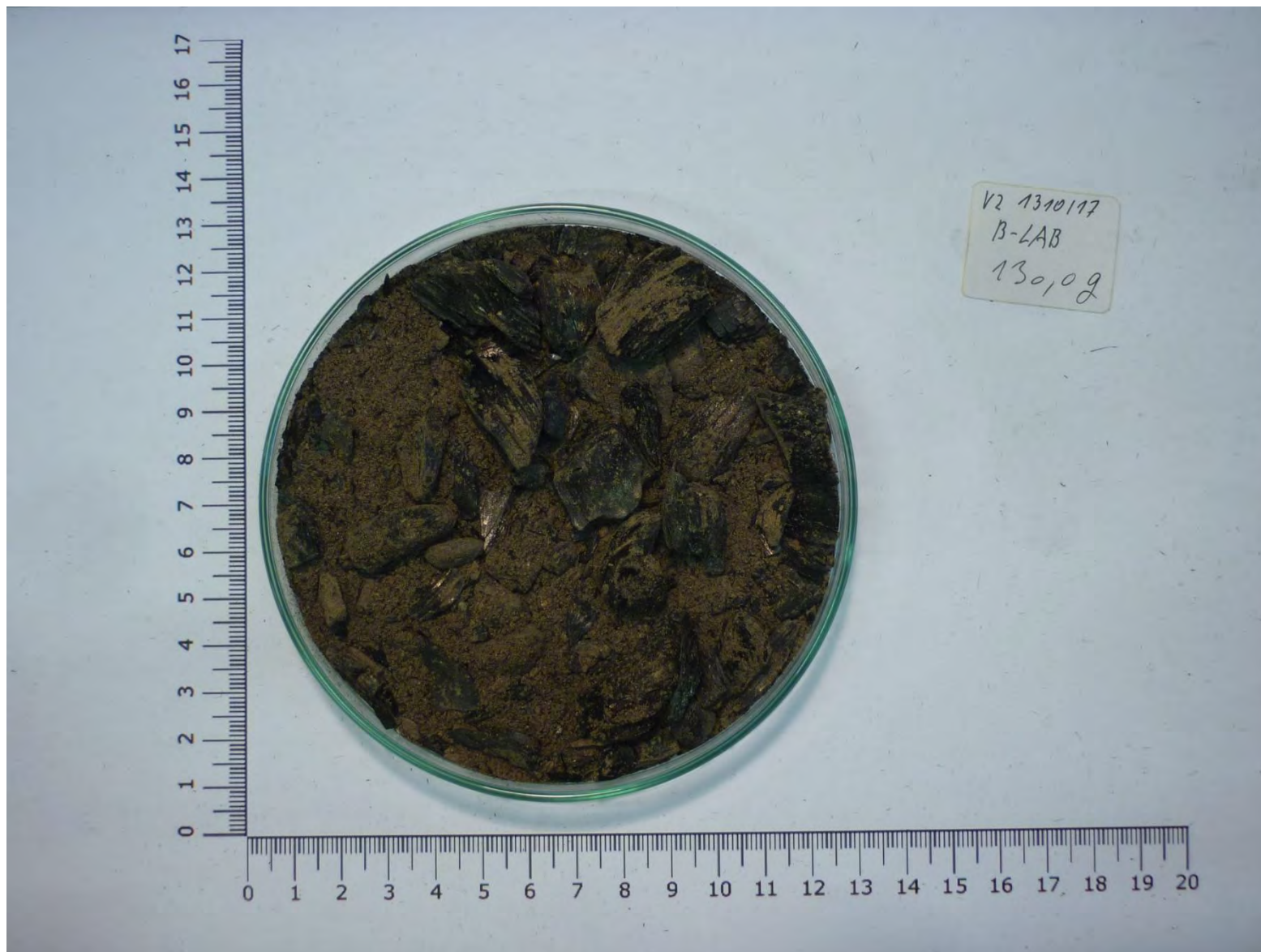
Obrázek 2.1.10-3 Reprezentativní část laboratorního vzorku
