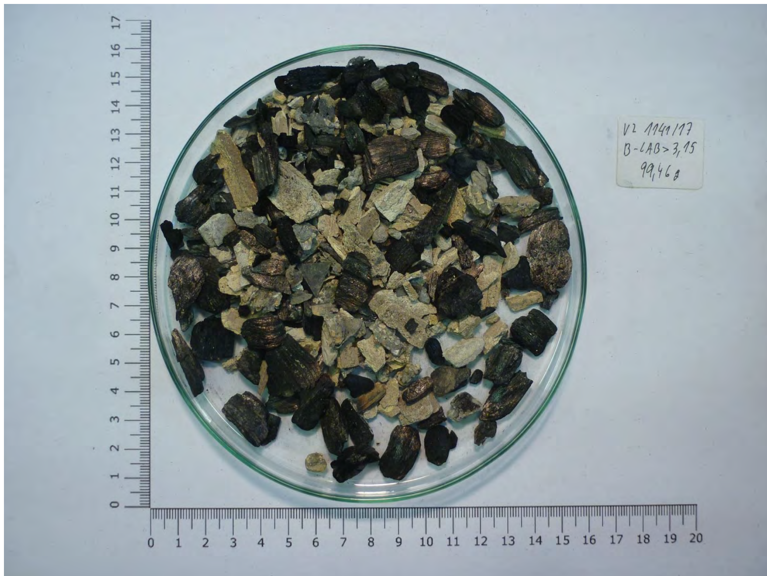
Obrázek 3.3.3-5 Reprezentativní část laboratorního vzorku (> 3,15 mm)
