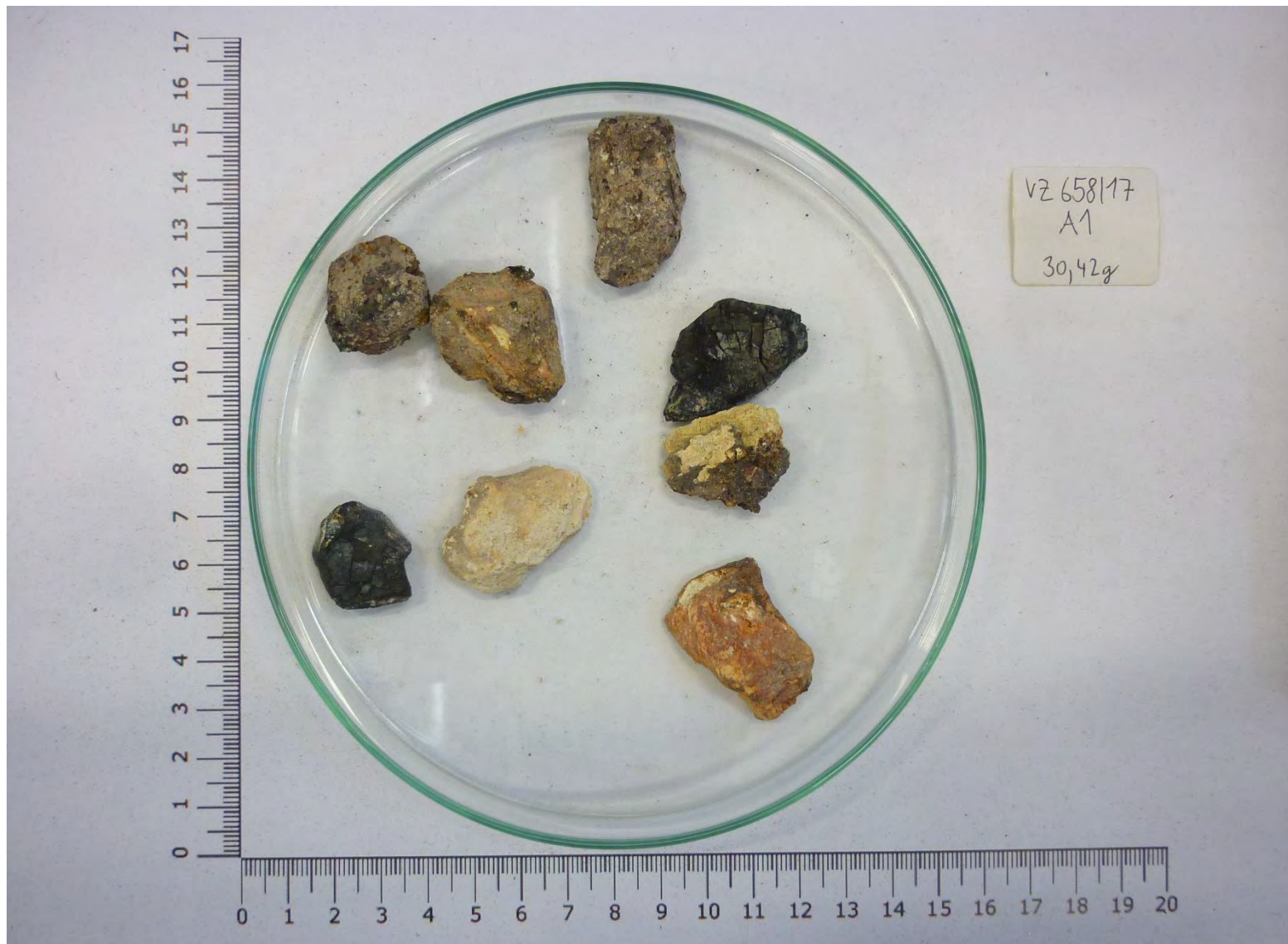
Obrázek 4.4.4-2 Nadsítná část celého vzorku (> 16 mm)
