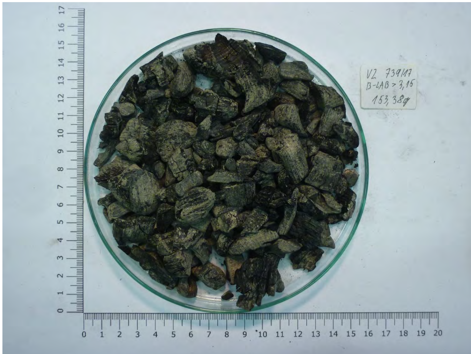
Obrázek 3.2.1-5 Reprezentativní část laboratorního vzorku (> 3,15 mm)
