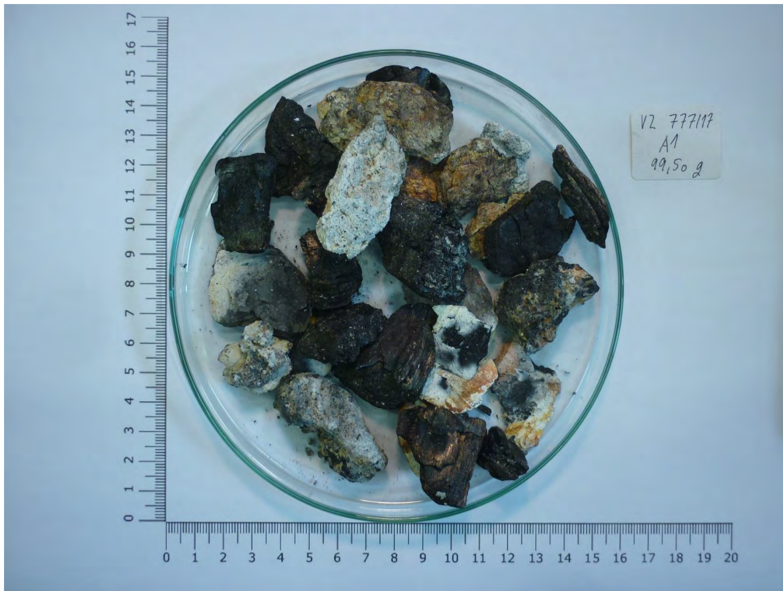
Obrázek 3.5.4-2 Nadsítná část celého vzorku (> 16 mm)
