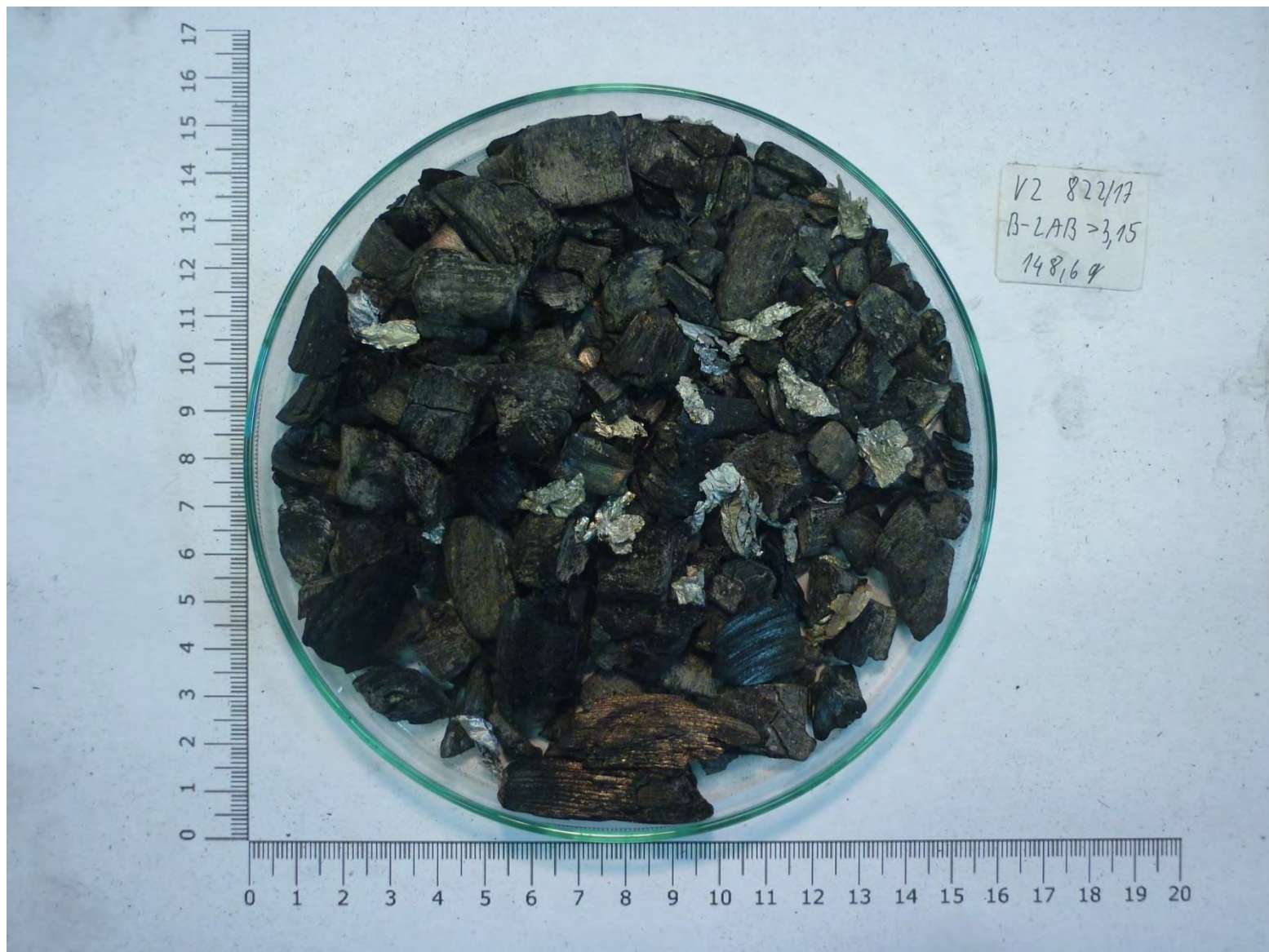
Obrázek 3.6.1-6 Reprezentativní část laboratorního vzorku (> 3,15 mm)
