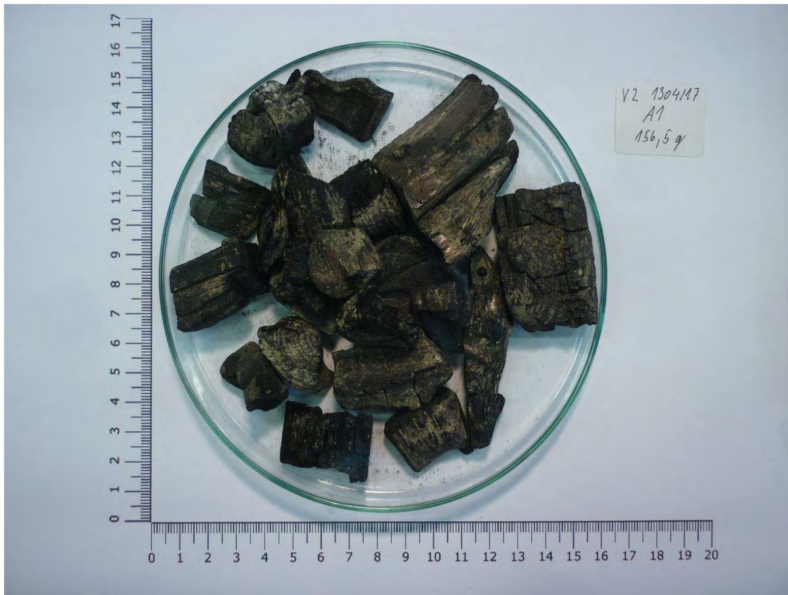
Obrázek 2.1.4-2 Nadsítná část celého vzorku (> 16 mm)
