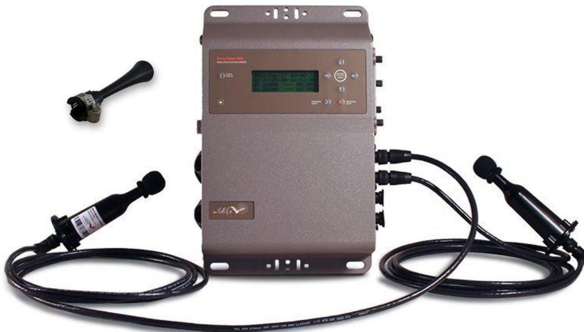
Obr. 9. Automatický detektor SM3Bat (Wildlife Acoustics, USA) s dvěma mikrofony. Vlevo nahoře nástavec na mikrofون, který umožňuje směřové snímání echolokace netopýrů (převzato z webu firmy).
