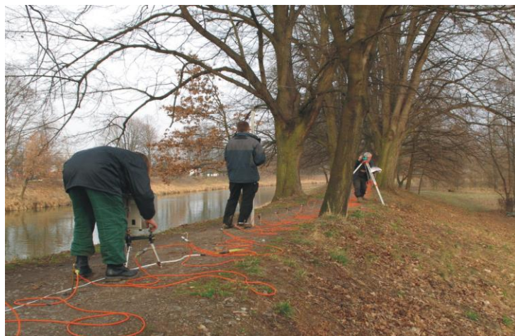
Obr. 2.1: Aplikace dvou geofyzikálních metod – gravimetrie a odporová metoda ERT
