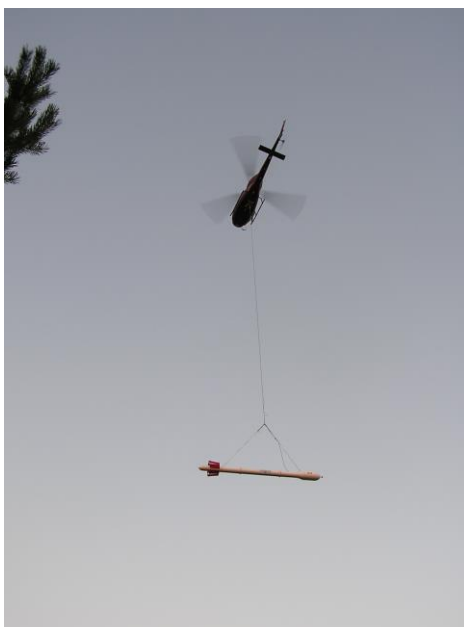
Obr. 3.19: Elektromagnetický systém zavěšený v konsoli pod helikoptérou
