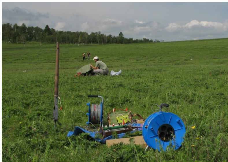
Obr. 3.2: Měření metodou vertikálního odporového sondování v terénu
