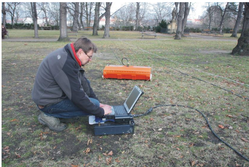
Obr. 3.9: Příprava měření geologickým radarem
