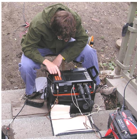
Obr. 3.10: Měření se seismickou čtyřiceti osmi kanálovou aparaturou
